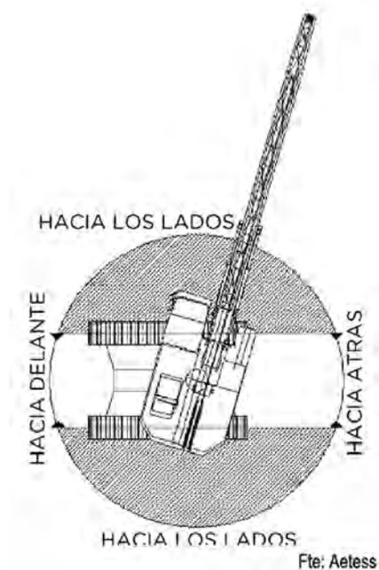
**Figura 12.** Grúas de cadenas con el centro de giro desplazado. Fuente: Aetess
