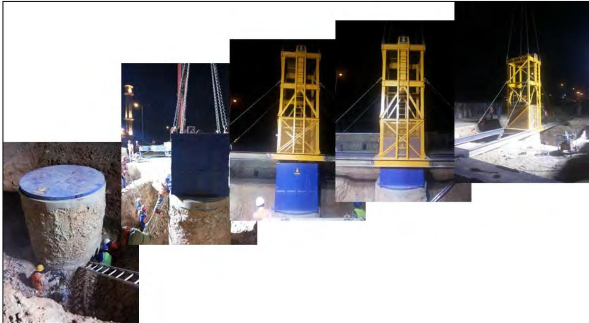
Figura 40. Preparación de un ensayo de carga dinámica en un mono-pilote de diámetro 2500 mm.
