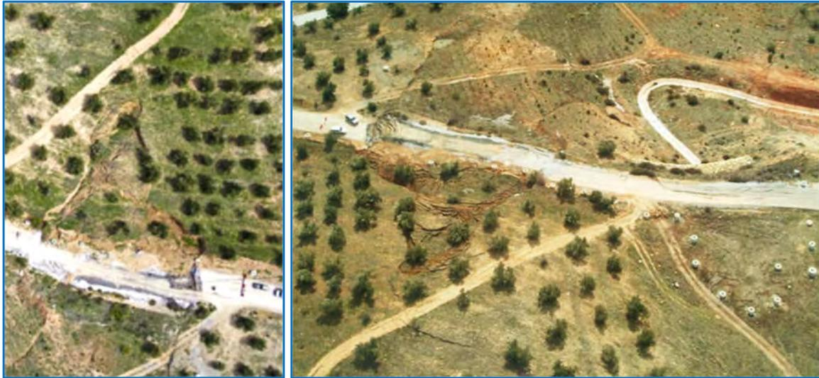
Figura 24. Reactivación de 2010. Vista desde ladera abajo (izq.; Ref. 7) y ladera arriba (dch.; Ref. 8)
