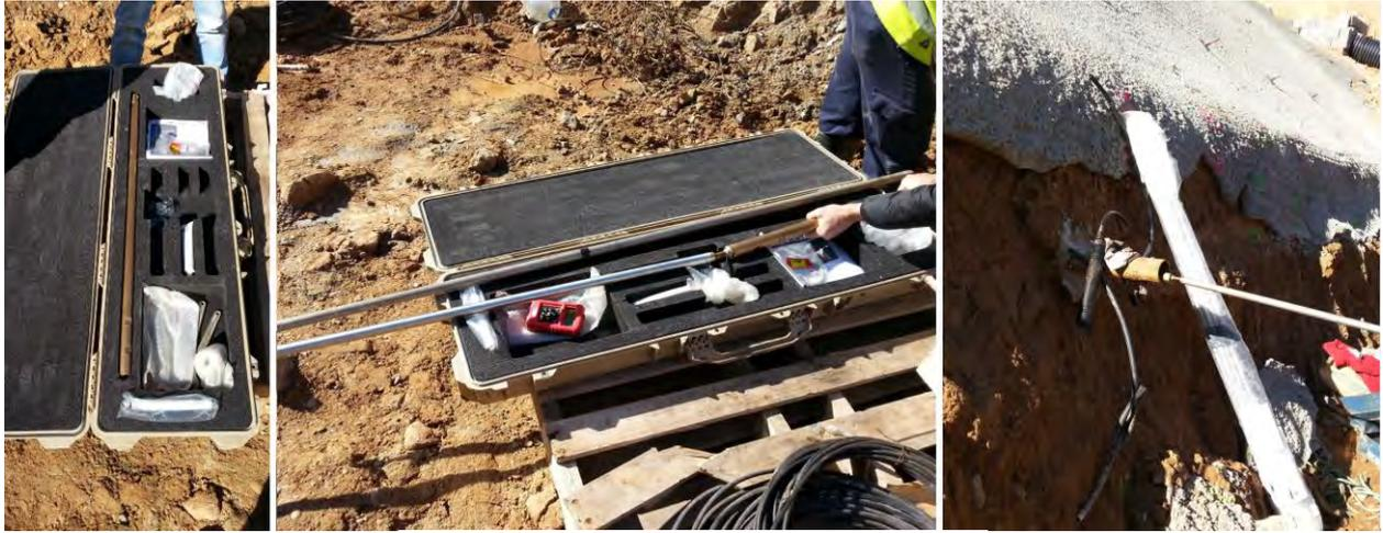
Fotografía 15. Inyecciones IRS. Obturadores.
