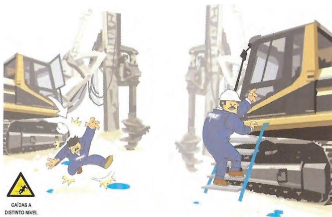
**Figura 78.** No se ha de saltar de la máquina; se deben utilizar los medios de acceso
