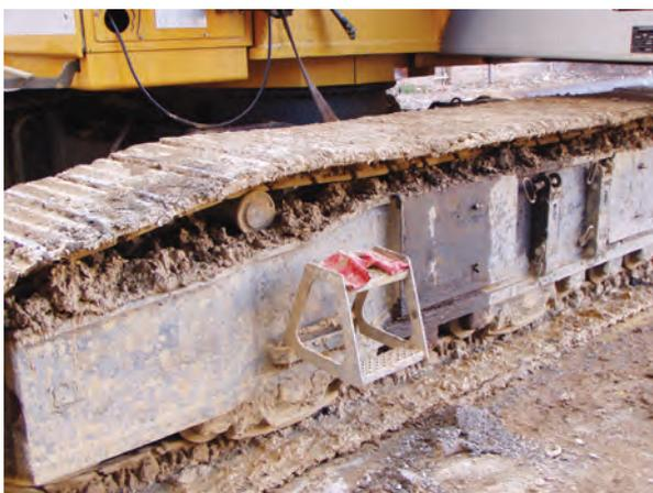
**Figuras 79 y 80.** Hay que reponer los medios de acceso deteriorados de la pilotadora y mantenerlos limpios y libres de objetos
