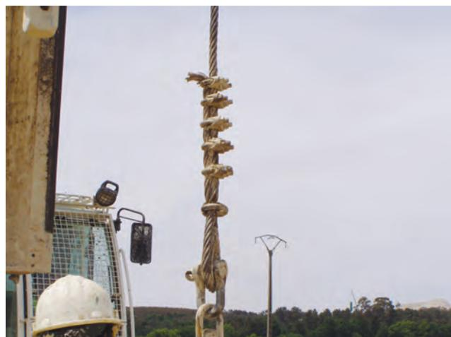
**Figura 126.** *Se ha de comprobar el estado de gomas, terminales, ganchos, grilletes y demás accesorios de elevación de cargas y sustituirlos en caso de deterioro*
