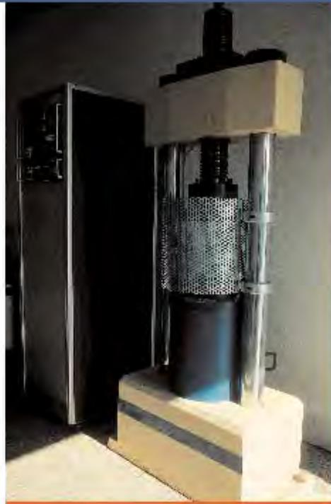
Ensayo de rotura y compresión de probetas de hormigón.
