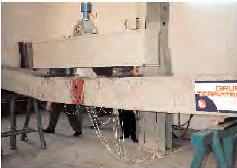
Ensayo de rotura a una junta
