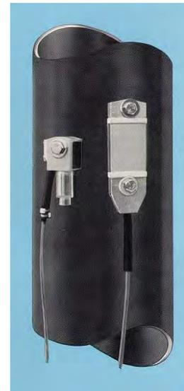
Figura 9. Disposiciones de los sensores según el tipo de pilote a ensayar
