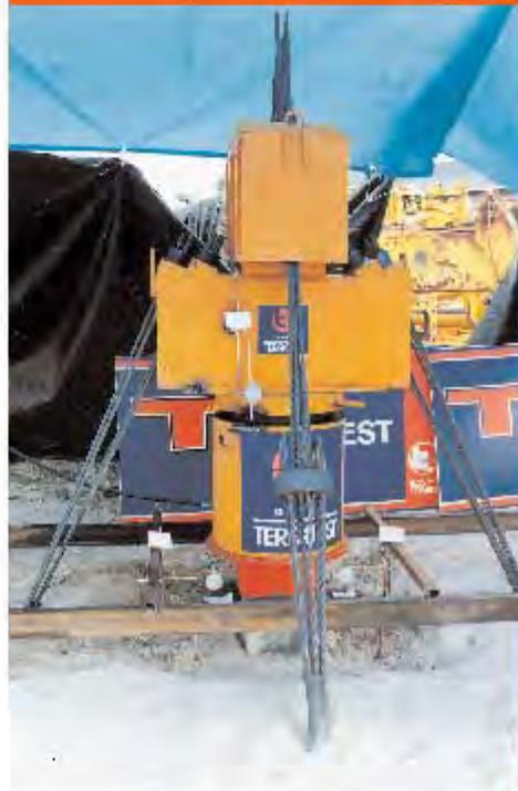
Pruebas de carga estática sobre pilote prefabricado.
