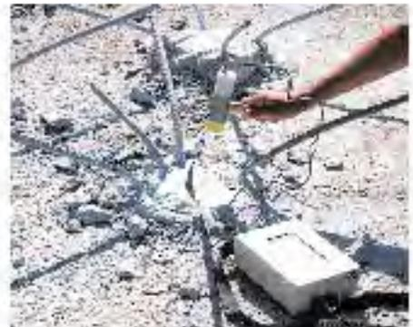
Ensayo de integridad PIT
