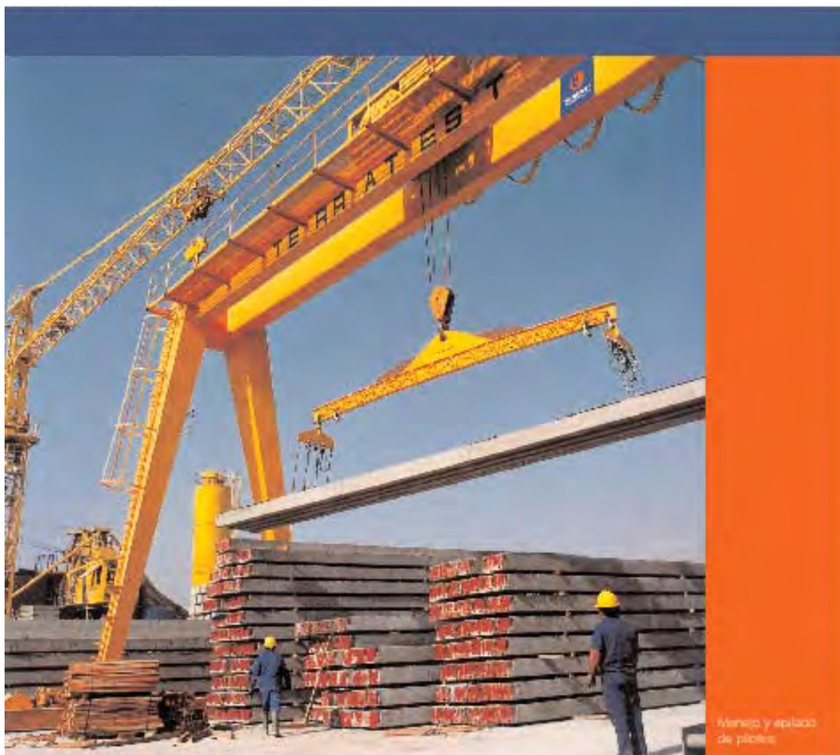
Los pilotes TERRA se fabrican en nuestras factorías de Cartagena y Sevilla, desde las cuales se envían a las diferentes obras, (tanto dentro como fuera de España), se fabrican desde una longitud mínima de 5 m hasta una máxima de 12 m, siendo empalmados para longitudes mayores mediante la junta de unión tipo ABB.
