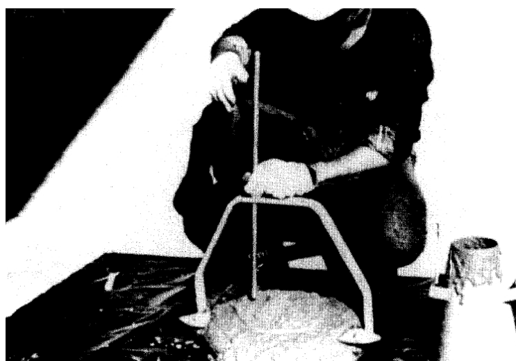
Fotografía 3: Hormigón de consistencia y cohesión adecuadas para cimentaciones especiales
