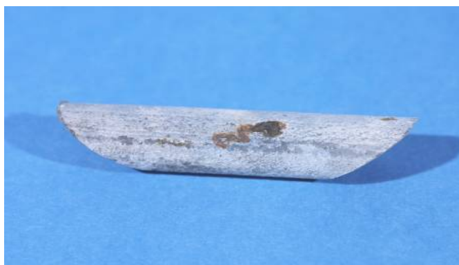
Figura 2.- Corrosión por picaduras. Armadura de un hormigón situado en ambiente marino. Foto cedida por el CEDEX.
