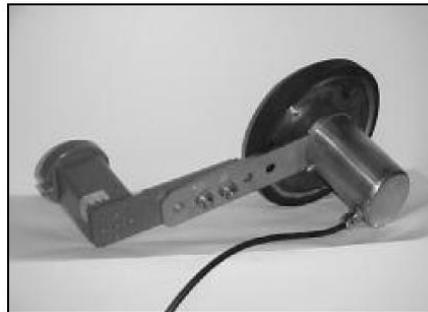
Figura 6: sensor de profundidad de EMPAREX.
