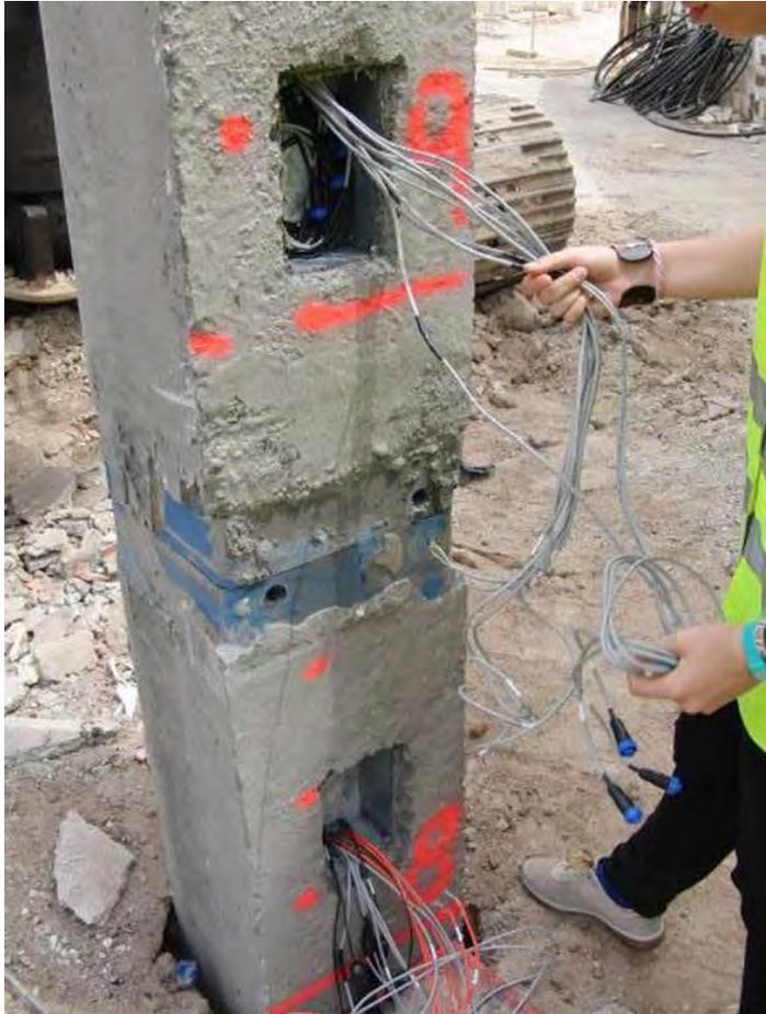
Figura 6. Instrumentación pilote prefabricado en proyecto PITERM (RK)
