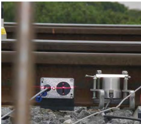
Foto 2. Sensor láser y geófono
