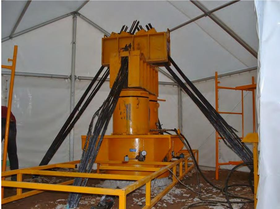
Figura 4. Reacción mediante anclajes al terreno (Terratest).
