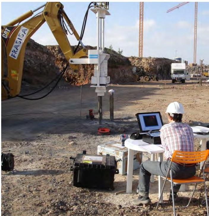
Figura 26. Prueba de carga dinámica sobre micropilote (RK)
