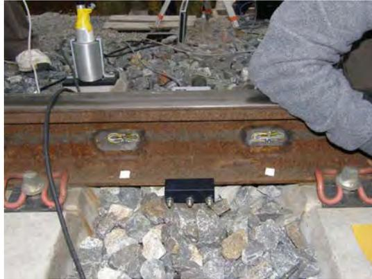
**Foto 1.- Colocación de bandas extensométricas en Cantoblanco**
