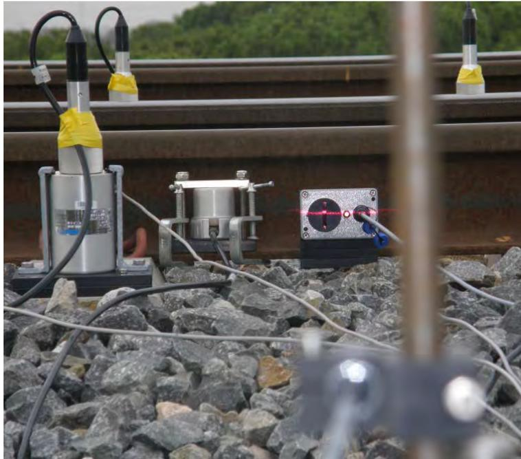
**Foto 7. Medida de deflexiones en traviesa (geófono izquierdo) y carril (geófono central y láser).**
