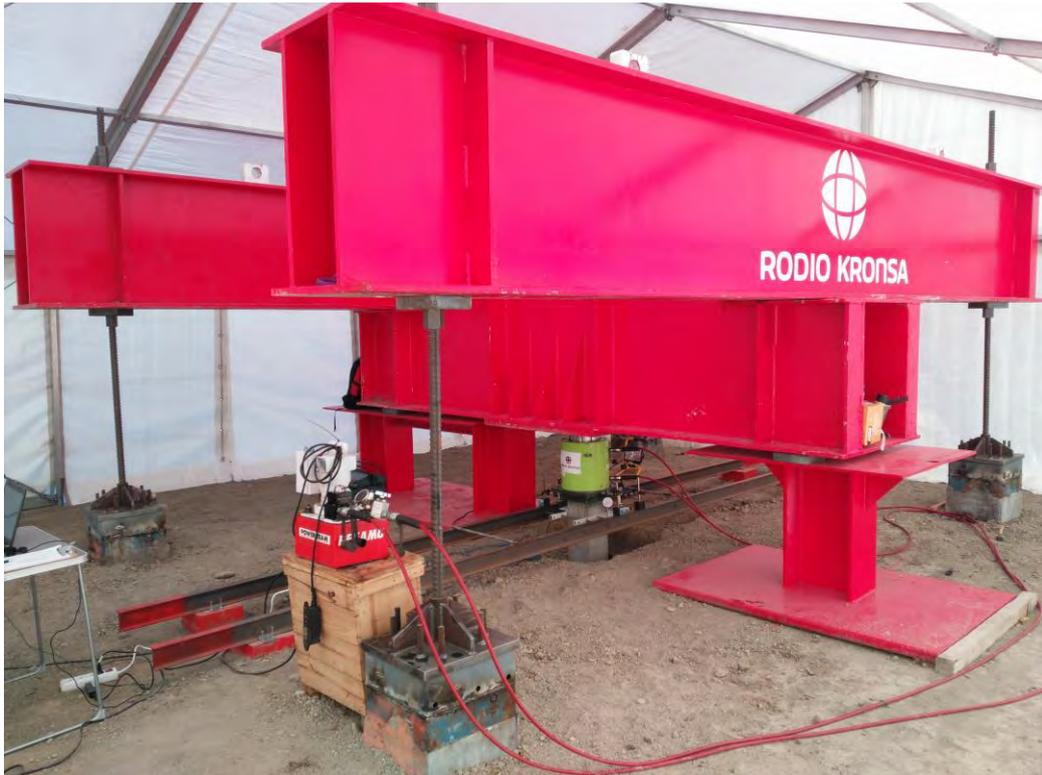
Figura 2. Ensayo de carga a compresión (RK)
