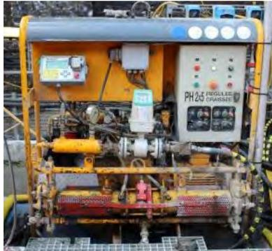
Figura 51. Bomba de inyección instrumentada y con control continuo de parámetros
