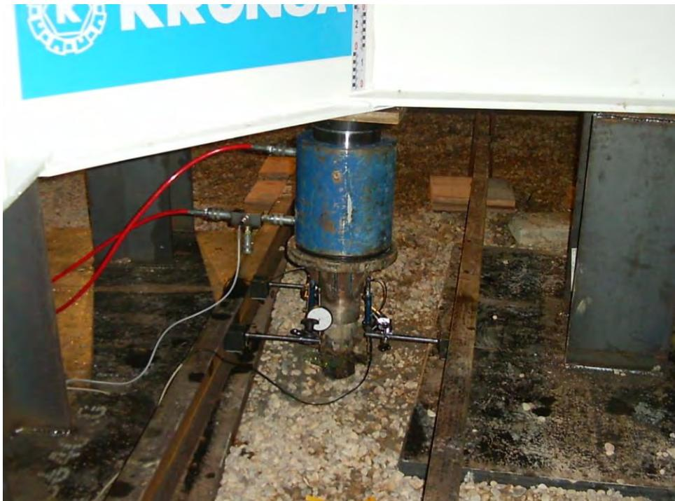
Figura 24. Prueba de carga estática sobre micropilote (RK)
