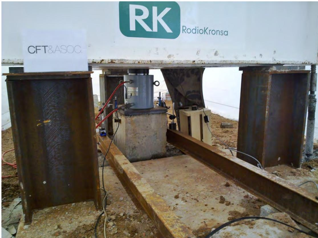
Figura 9. Prueba de carga cíclica (RK)
