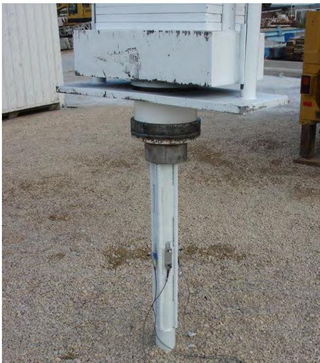
Figura 22. Martillo e instrumentación en el micropilote (RK)
