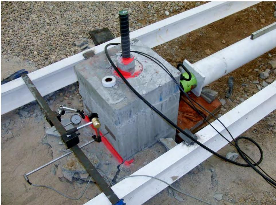
Figura 12. Instrumentación de prueba de carga lateral (RK)
