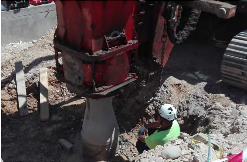
Figura 21. Prueba de carga dinámica sobre pilote in situ con martillo de hincia (RK)
