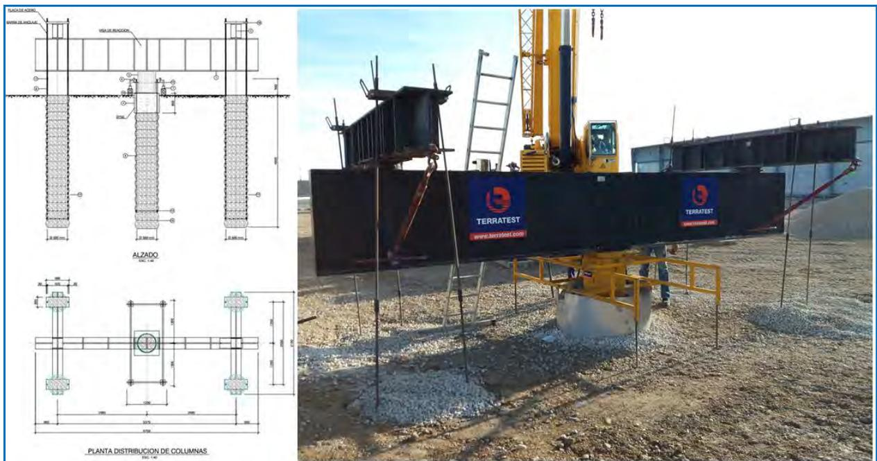
Figura 27. Plano e imagen del montaje para en ensayo de módulo
