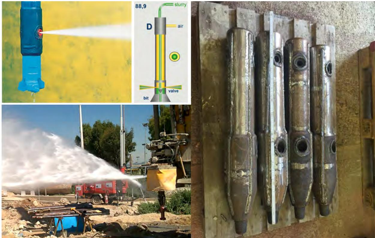
**Figura 14: Ejemplo de monitores convencionales y monitores especiales tipo DX.**
