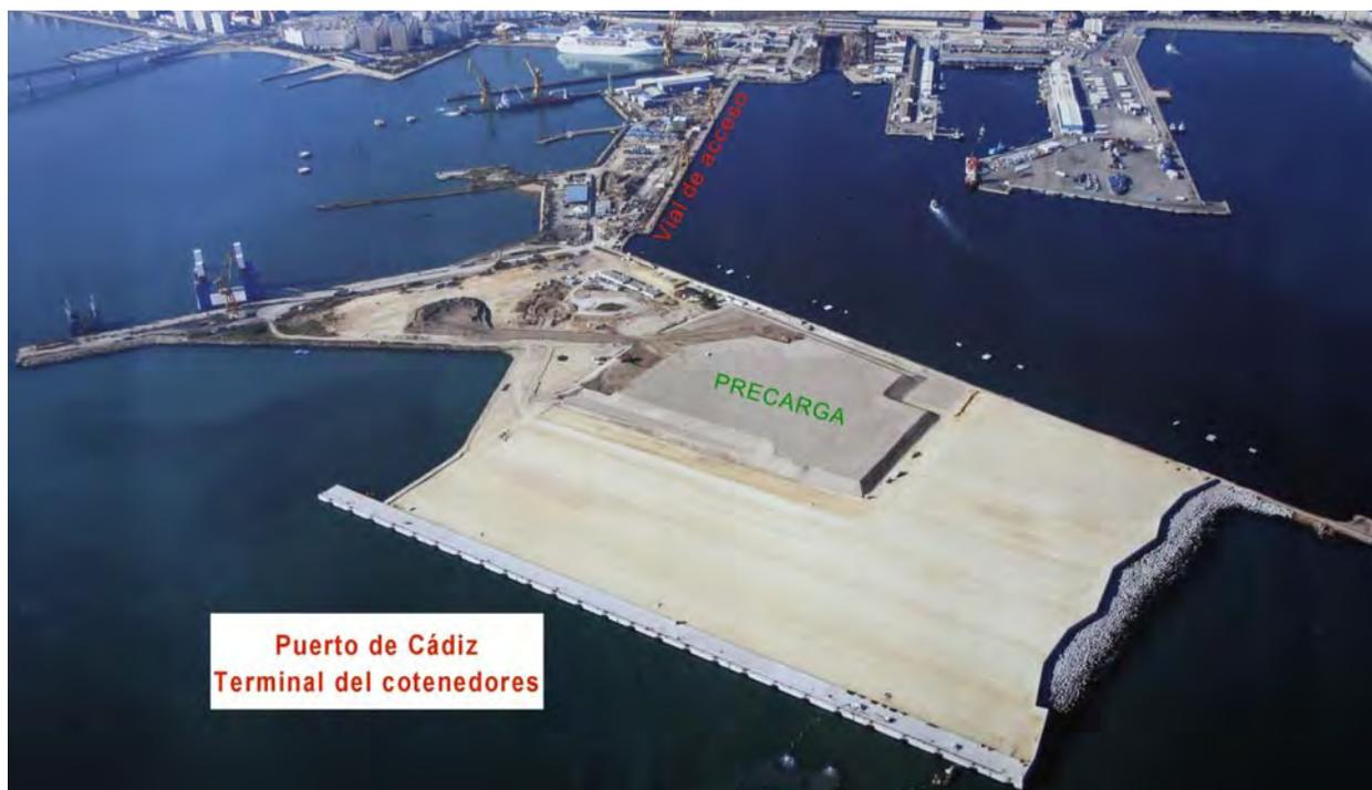
Figura 10. Nueva terminal de contenedores del Puerto de Cádiz durante la retirada de la precarga de la 3ª fase
