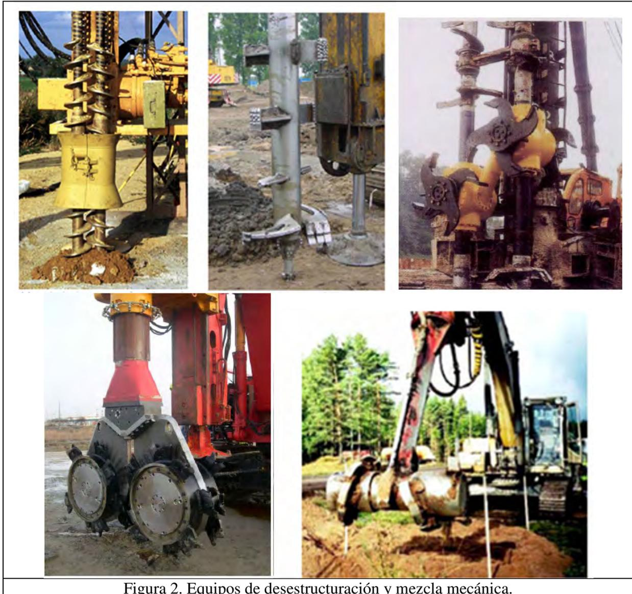
Figura 2. Equipos de desestructuración y mezcla mecánica.
