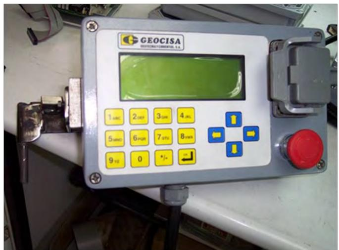
Figura 2. Equipo de medida de los parámetros de perforación: SLOGGER
