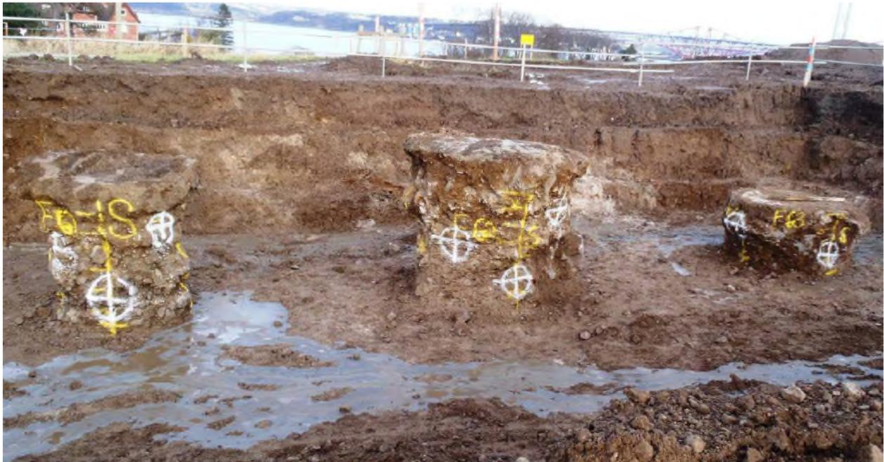
*Figura 7. Campo de pruebas para el Jet Grouting.*
