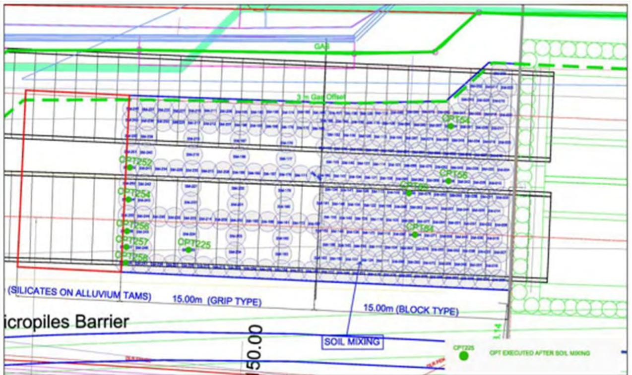
Figura 20. Situación de los CPT después del deep soil mixing
