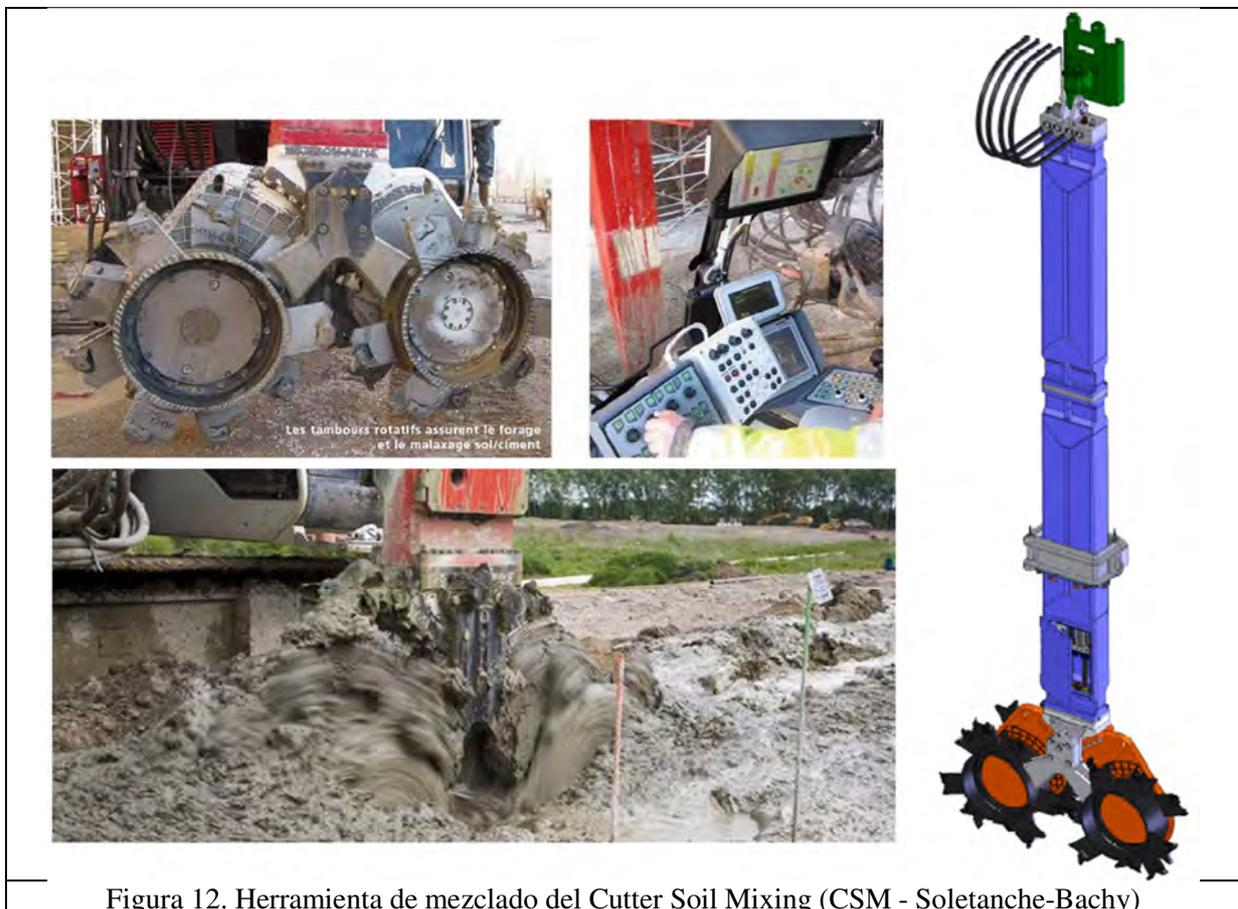
Figura 12. Herramienta de mezclado del Cutter Soil Mixing (CSM - Soletanche-Bachy)
