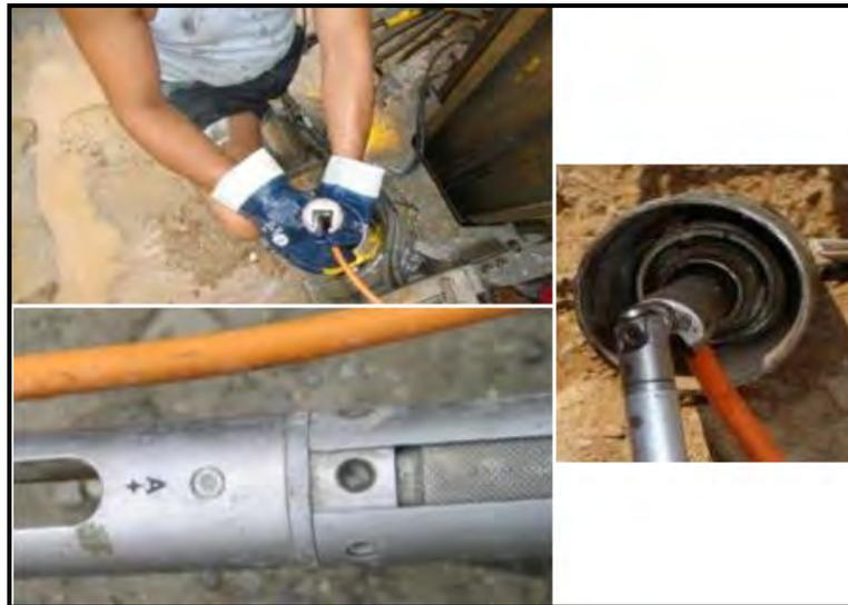
Figura 15: Control de verticalidad mediante Sistema INCLIJET®.
