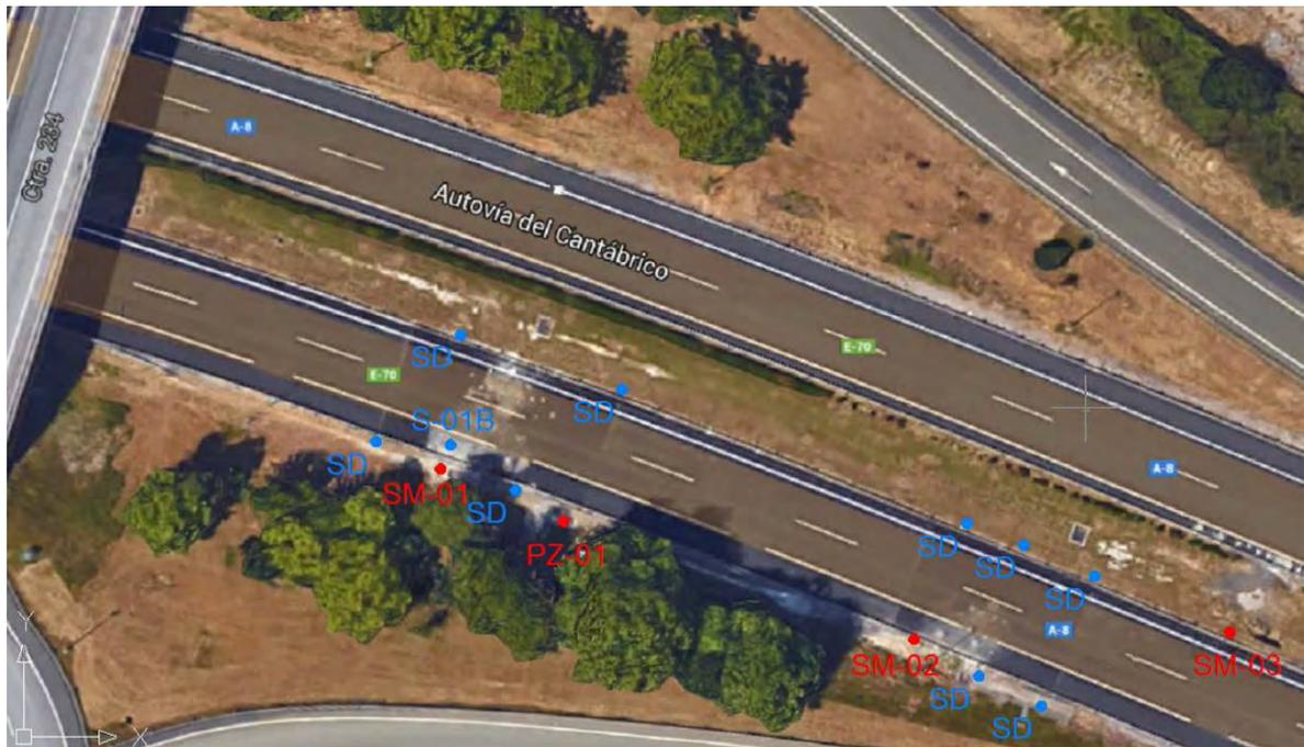
Figura 6 - Sondeos micrométricos previstos en la zona A8\_1 lado Este de la Estructura del Enlace (color rojo) y taladros a destroza planteados para la identificación de cavidades (color azul) (Google, 2017).
