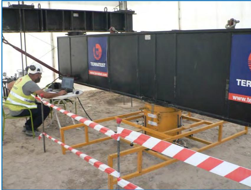
Figura 16. Imagen del montaje de un ensayo de carga sobre columna GeoConcrete
