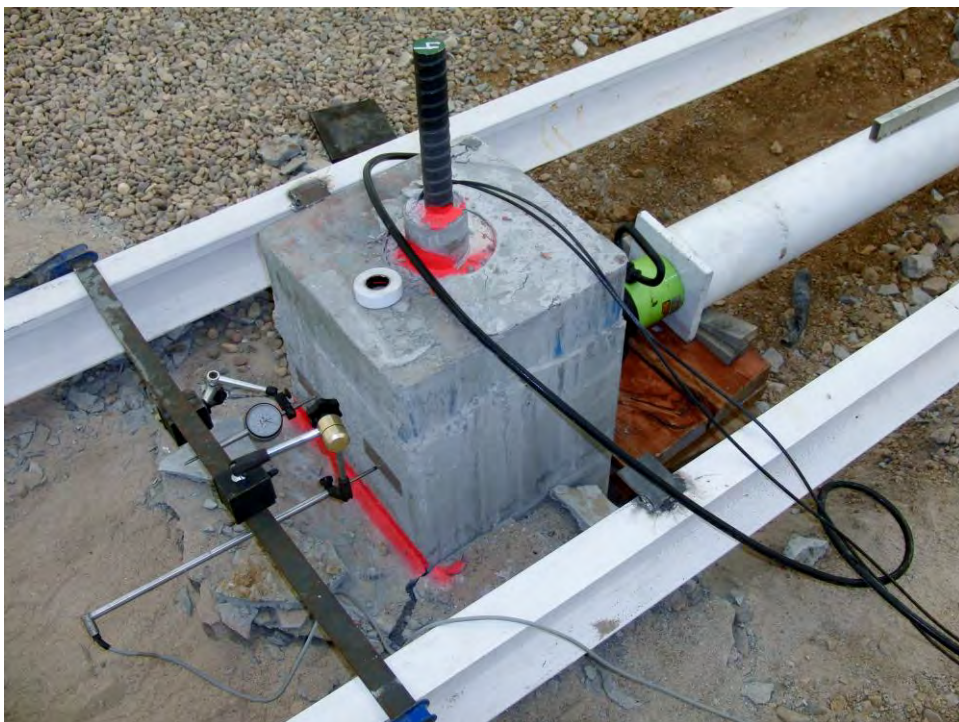
Figura 12. Instrumentación de prueba de carga lateral (RK)
