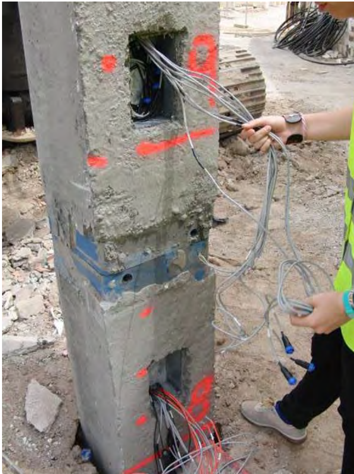
Figura 6. Instrumentación pilote prefabricado en proyecto PITERM (RK)
