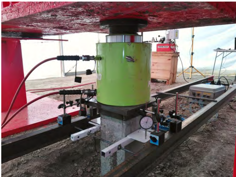
Figura 3. Instrumentación de prueba de carga a compresión (RK)
