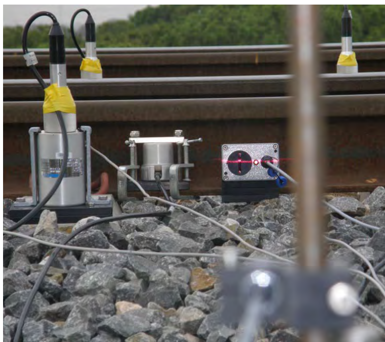
Foto 7. Medida de deflexiones en traviesa (geófono izquierdo) y carril (geófono central y láser).
