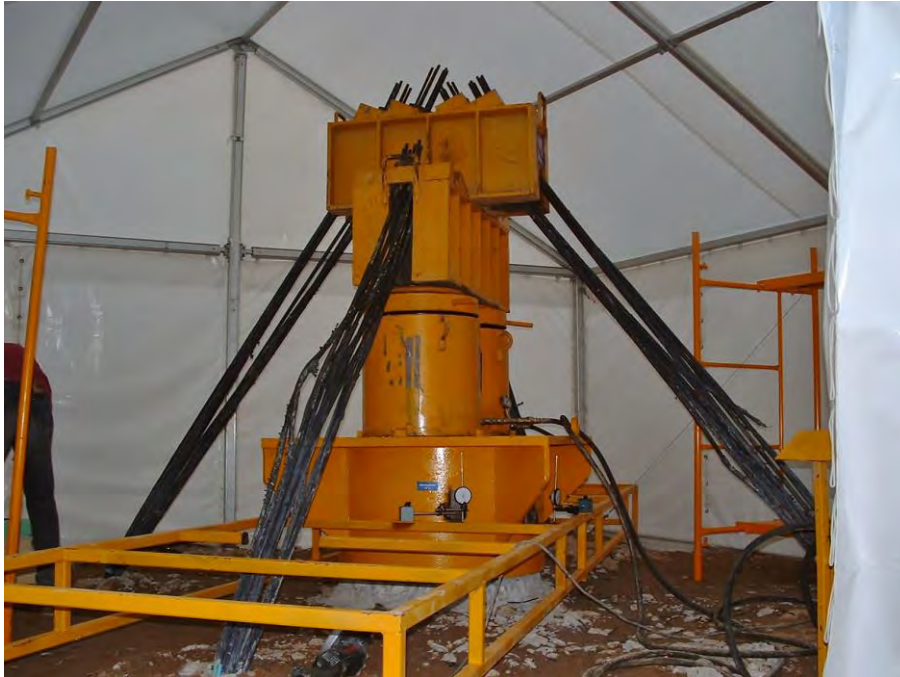
Figura 4. Reacción mediante anclajes al terreno (Terratest).
