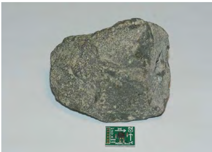
Foto 11. Partícula de balasto instrumentada
