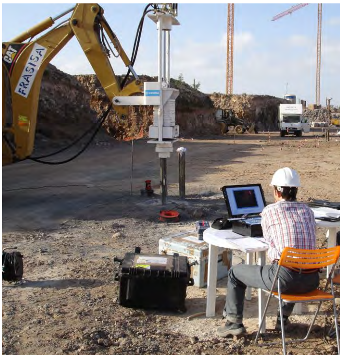
Figura 26. Prueba de carga dinámica sobre micropilote (RK)
