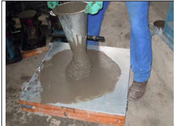
Ensayo de cono invertido. Medida de tiempo para vaciar el cono que se relaciona con viscosidad del hormigón
