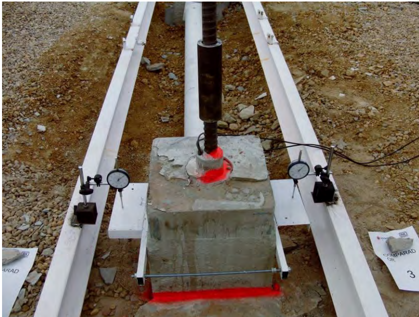
Figura 10. Instrumentación con relojes comparadores en prueba de carga a tracción (RK)
