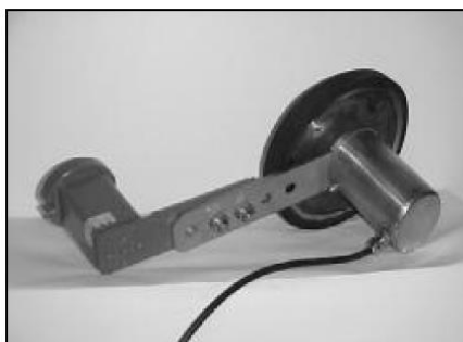
Figura 6: sensor de profundidad de EMPAREX.
