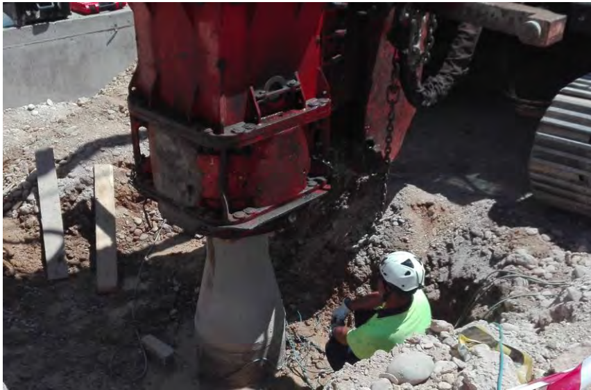
Figura 21. Prueba de carga dinámica sobre pilote in situ con martillo de hinca (RK)
