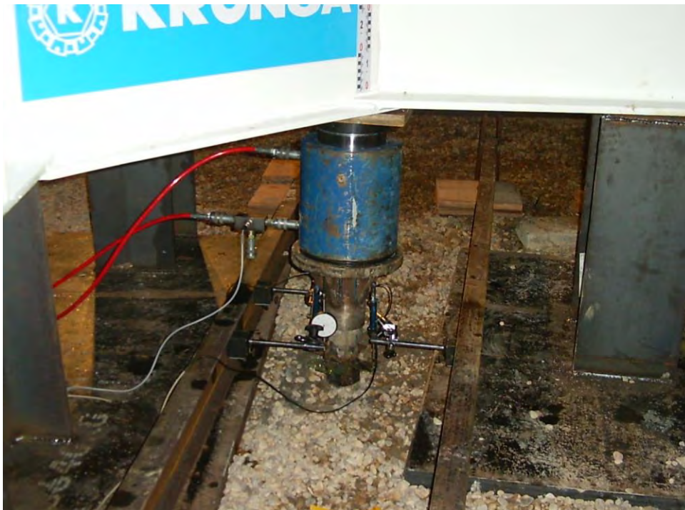
Figura 24. Prueba de carga estática sobre micropilote (RK)
