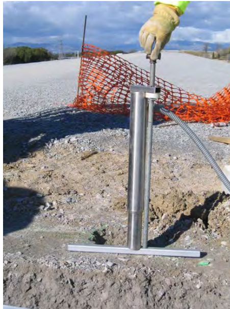
Foto 5. Sensor LVDT utilizado en la capa de balasto
