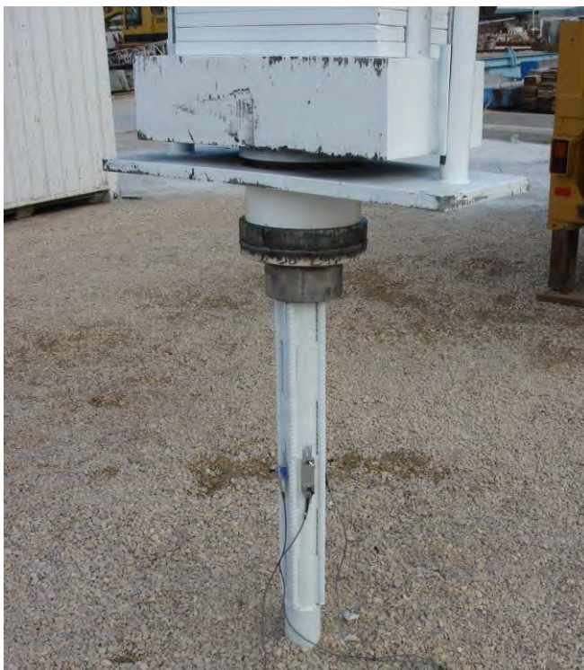
Figura 22. Martillo e instrumentación en el micropilote (RK)
