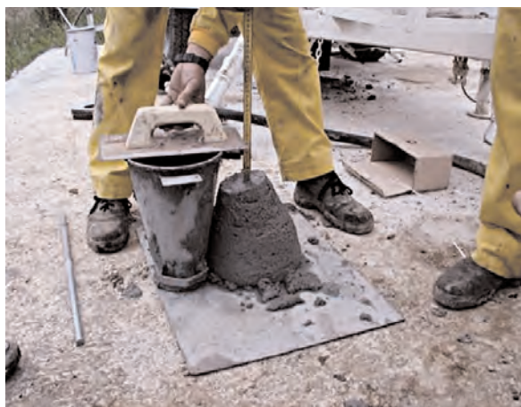
Figura 3. CONTROL DE ASIENTO EN CONO DE ABRAMS: < 5 cm (gentileza de Geocisa).
