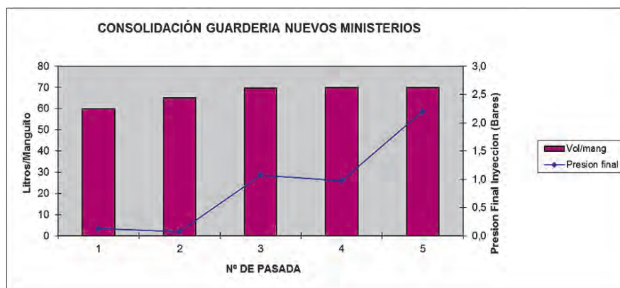
Figura 25. RESULTADO DE LAS CINCO FASES DE INYECCIÓN EN LA GUARDERÍA (gentileza de Geocisa).
