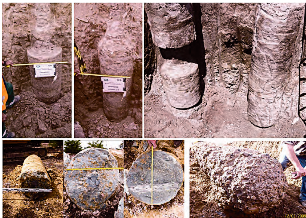
Figura 18. COLUMNAS EXCAVADAS (Sup. dcha.: Control de cierre y apertura de brazos de corte).
