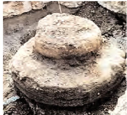
Figura 11. COLUMNA DE SUPERJET-GROUTING REALIZADA CON LOS MISMOS PARÁMETROS DE EJECUCIÓN EN DOS CAPAS DE GRANULOMETRÍA DIFERENTE.
