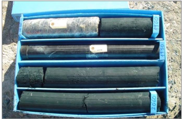
Figura 23. Ejecución de sondeos y toma de muestras en la pantalla
