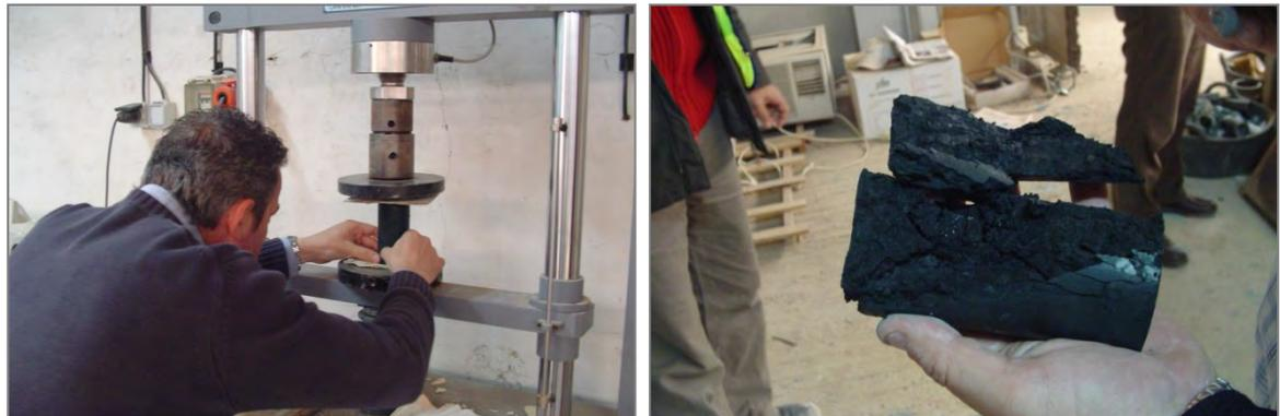
Figura 21. Ensayos de rotura a compresión simple de muestras de bentonita-cemento
