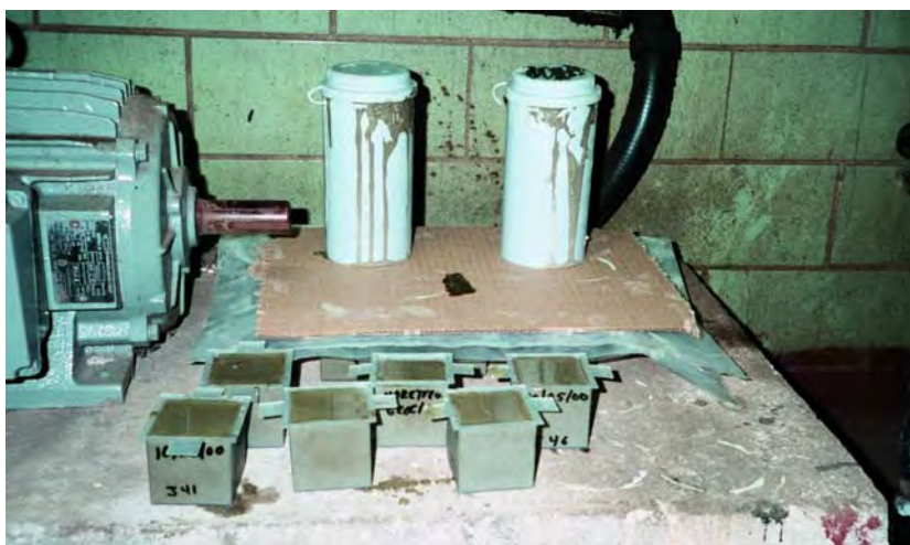
Figura 20. MUESTRAS CÚBICAS DE LECHADA PARA ENSAYOS DE LABORATORIO
