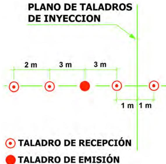
Figura 12. COMPROBACIÓN DEL EFECTO DE LA INYECCIÓN MEDIANTE ENSAYOS *CROSS-HOLE* (Santos y Cuéllar, 2000).
