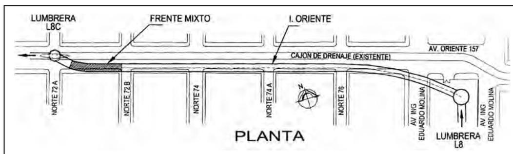
Foto 35. TRAZADO EN PLANTA DEL TRAMO DE CONEXIÓN FINAL, PRÓXIMO AL CAJÓN EN SUPERFICIE.
