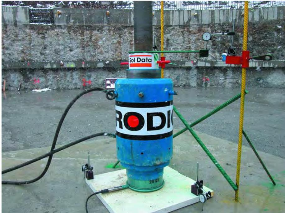
Foto. 46. DETALLE DE LA PRUEBA DE CARGA DE UN MICRO.
