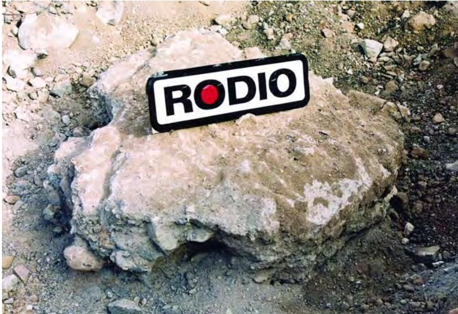
**Foto 34. VISTA DE UNA DE LAS COLUMNAS DEL CAMPO DE PRUEBAS. DEBEN OBSERVARSE SUS DIMENSIONES Y CÓMO ENGLOBA LOS MATERIALES EXISTENTES FORMANDO UN TODO UNO RELATIVAMENTE HOMOGÉNEO; FRUTO DE ELLO SU SUPERFICIE EXTERIOR LATERAL QUE GARANTIZA UNA EXCELENTE ADHERENCIA COLUMNA-SUELO.**
