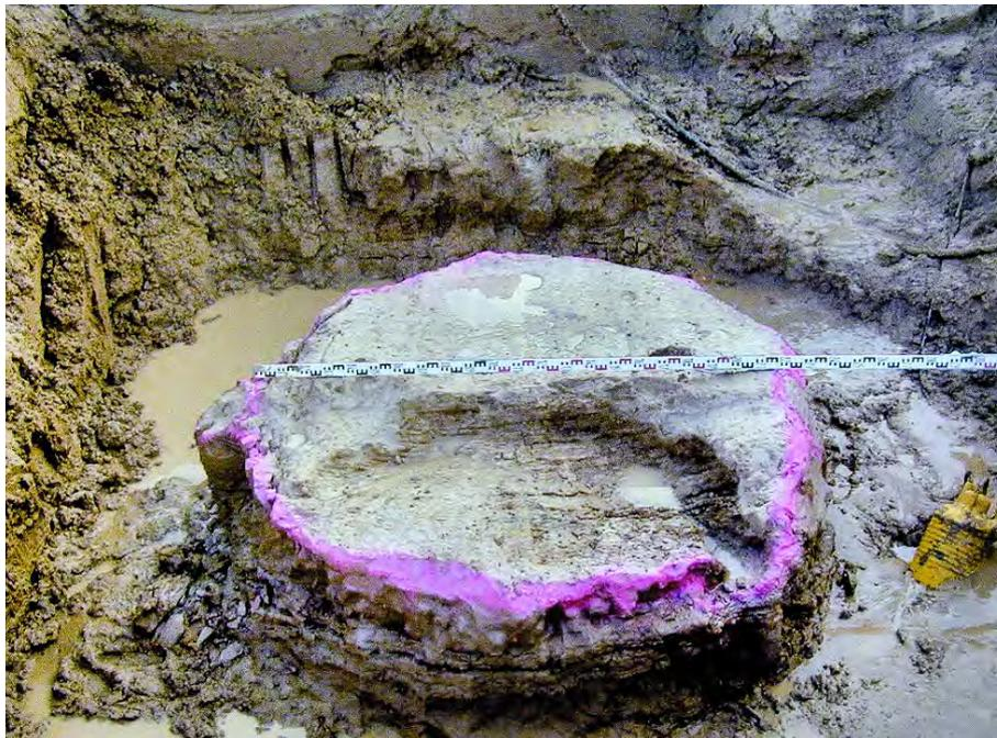
**Foto No. 4. PRUEBA DE CAMPO DE SUPERJET-GROUTING EN TERRENO ARCILLOSO ( $\varnothing = .30$  m).**
