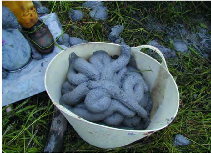
**Figura 16. MORTERO "SECO" PARA INYECCIONES DE BAJA MOVILIDAD.**
