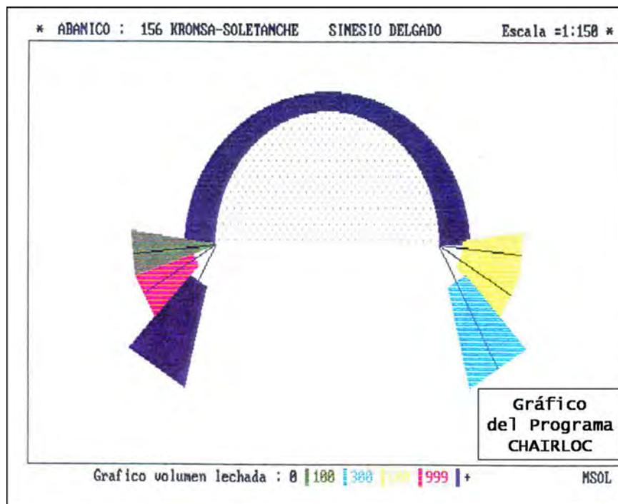
Figuras 8 y 9. GRÁFICO DE SECCIÓN DEL TÚNEL Nº 2, RECOGIENDO LAS PRESIONES MEDIAS Y EL VOLUMEN INYECTADO EN LA CERCHA 156. (Elaborado automáticamente por el Programa CHAIRLOC a partir de los datos aportados por el Sistema SINNUS-2.)
