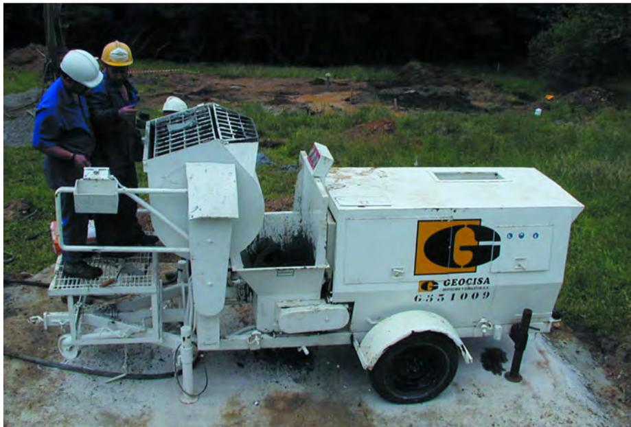
Figura 14. BOMBA PARA INYECCIÓN DE MORTEROS "SECOS".
