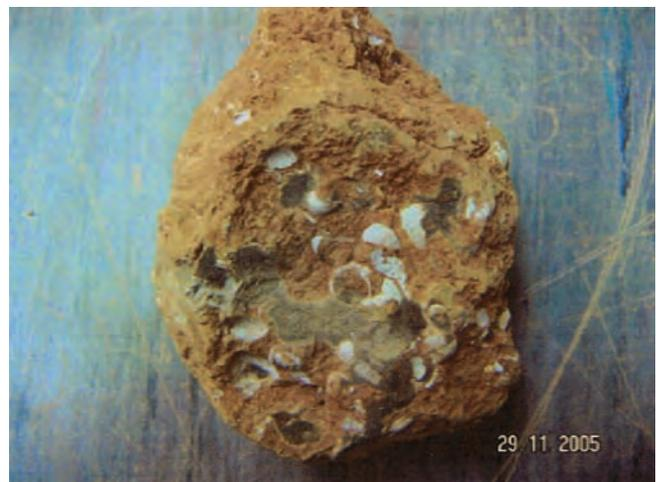
**Figura 12. DETALLE DE IMPREGNACIÓN Y RELLENO DE OQUEADES EN LIMOS CON RESTOS ORGÁNICOS.**
