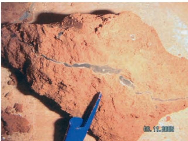
**Figura 11. DETALLE DE LAJAS Y TUBIFICACIONES.**
