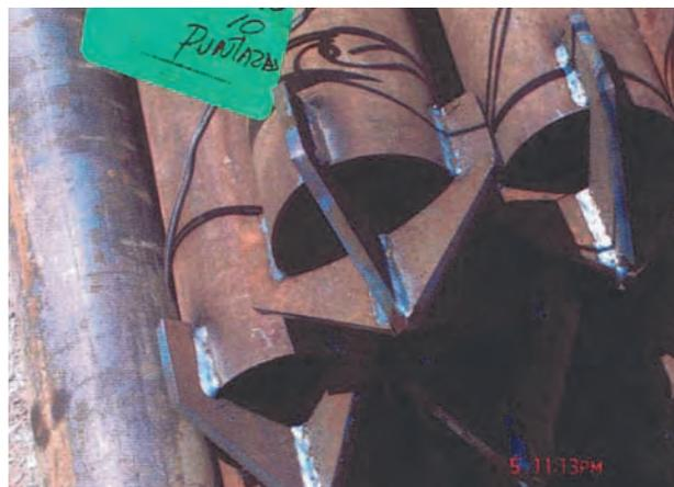
Figura 36. MICROPILOTES AUTOPERFORANTES.
