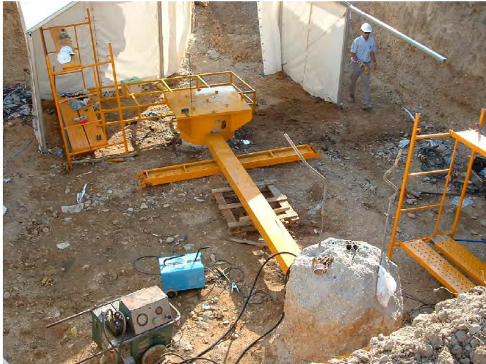
Figura 9.- Imagen de la preparación de la prueba horizontal, con pilote de reacción en primer término y pilote auscultado en segundo término.
