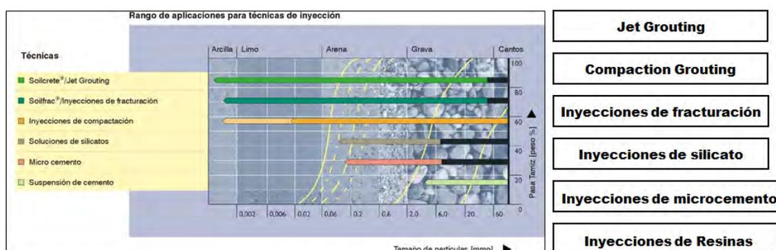
Figura 14: APLICABILIDAD DE LAS TÉCNICAS DE INYECCIÓN DE ACUERDO A LA GRANULOMETRÍA DEL SUELO.
