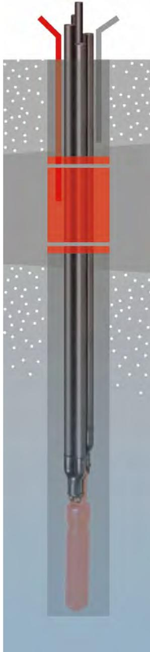
**Figura 5. Esquema de sonda geotérmica doble con tubo central para cementación y lastre suspendido del pie de sonda (Fuente: HakaGerodur).**
