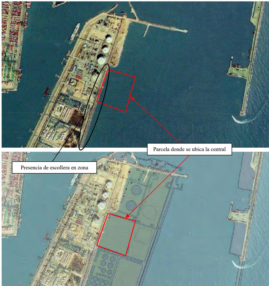
Figura 13.- Ortofoto correspondiente al estado del muelle en 1993 donde se puede apreciar la ubicación de la antigua escollera.
