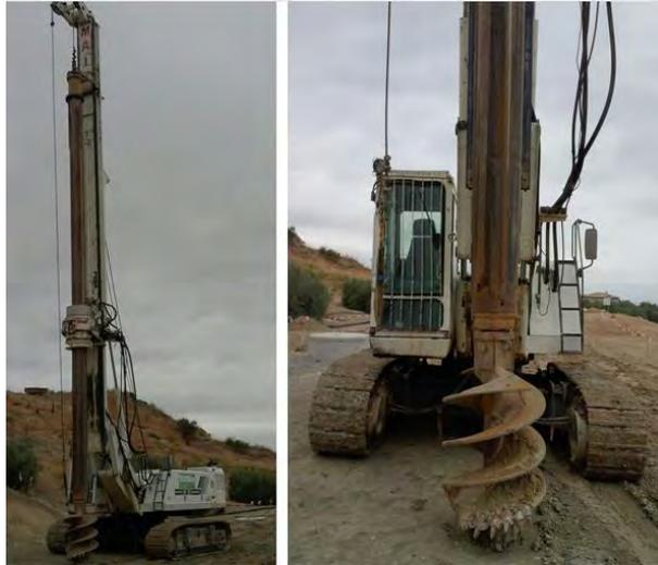
**Figura n° 28: Máquina de perforación hidráulica a rotación**
