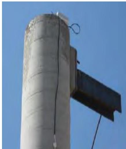
*Figura n°5: Colocación de viga para ensayo a torsión.*
