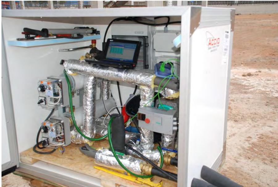
**Foto 9. Interior de un equipo para ensayo de respuesta térmica del terreno. (Fuente: Girod).**
