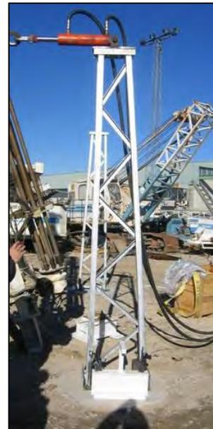
Figura 8.- Prueba de carga horizontal
