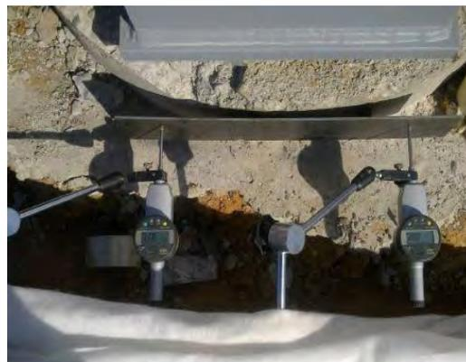
**Figura nº 8** Colocación de micrómetros para medidas del desplazamiento
