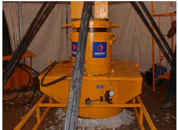
Figura 5.- Realización de la prueba vertical
