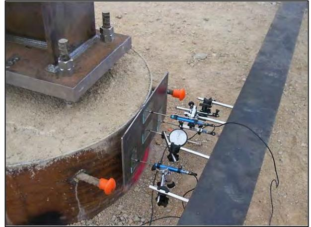
Figura 12.- Instrumentación en cabeza del pilote
