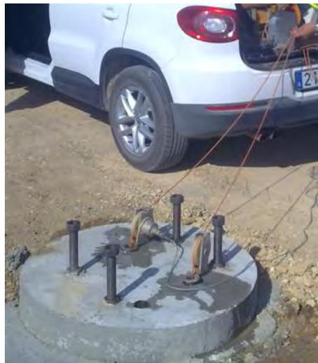
*Figura n°2: Ensayo de integridad en la cabeza del pilote*
