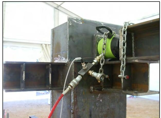
Figura 14.- Gato y viga de transmisión de la carga
