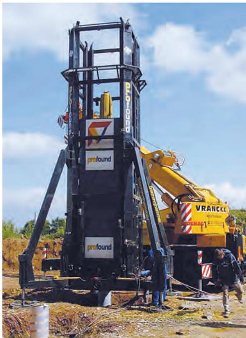
Figura 7. MÉTODO STATNAMIC DE CARGA DE PILOTES.
