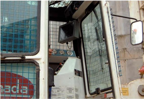
Figura 28. CABINA DE CONTROL PARA REGISTRO DE PARÁMETROS DE PERFORACIÓN E INYECCIÓN (Gentileza de Acciona).
