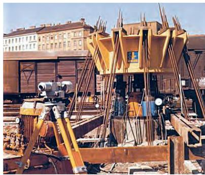
Figura 4. REACCIÓN CON ANCLAJES.
