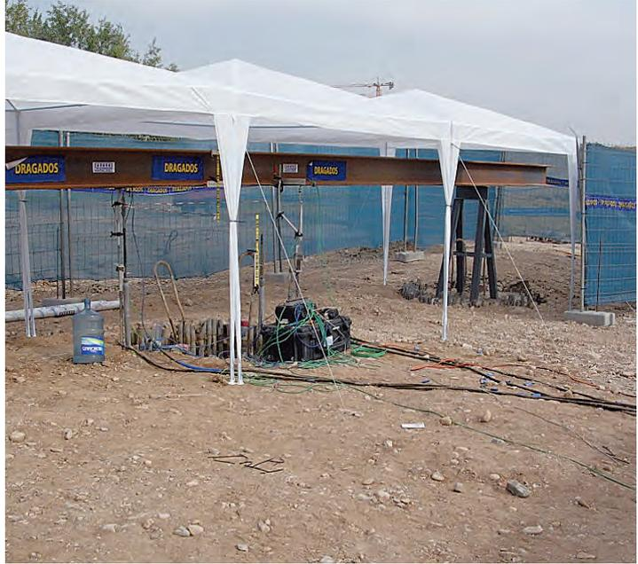
Figura 48. PROTECCIÓN DE LA VIGA DE REFERENCIA Y NIVEL PARA LA MEDIDA DE MOVIMIENTOS.
