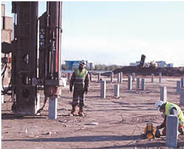
Figura 10. ENSAYO DINÁMICO EN PILOTES PREFABRICADOS.
