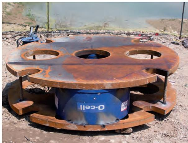
Figura 29. CÉLULAS OSTERBERG MONTADAS.
