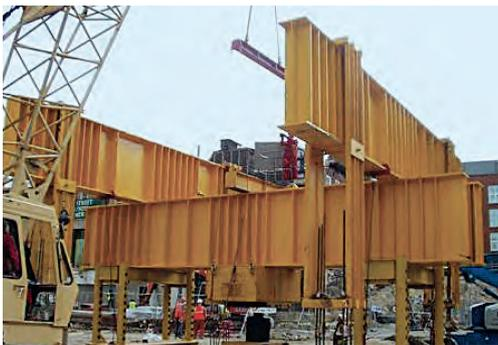
Figura 3. REACCIÓN CON PILOTES A TRACCIÓN.
