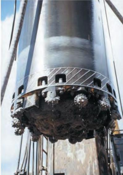
Figura 19. CORONA TIPO BAUER PARA CORTAR Y PENETRAR EN EL BASALTO (Gentileza de Terratest).
