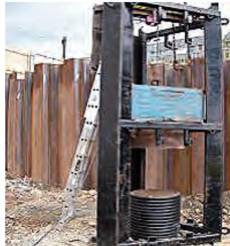
Figura 11. ENSAYO DINÁMICO EN PILOTES *IN SITU*.
