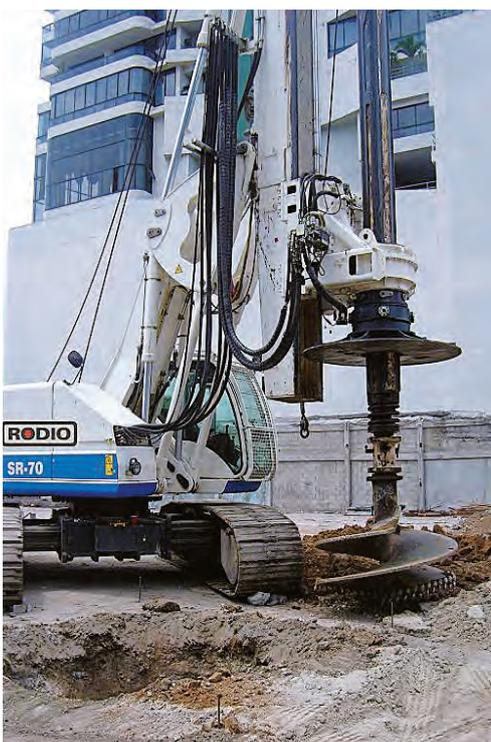
Figura 57. EQUIPO DE PERFORACIÓN A ROTACIÓN TIPO SR-70.
