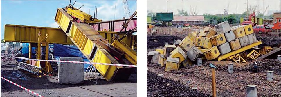
Figura 6. PROBLEMAS CON LOS SISTEMAS DE REACCIÓN DURANTE LA EJECUCIÓN DEL ENSAYO DE CARGA ESTÁTICA.
