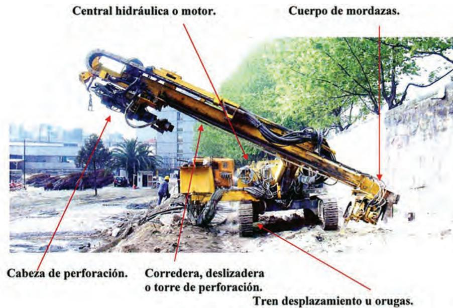
**Figura 18.** Partes de una perforadora
