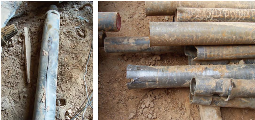
**Figuras 32 y 33.** Rotura del varillaje
