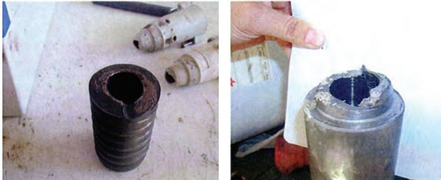
**Figuras 34 y 35.** Rotura en la rosca del varillaje
