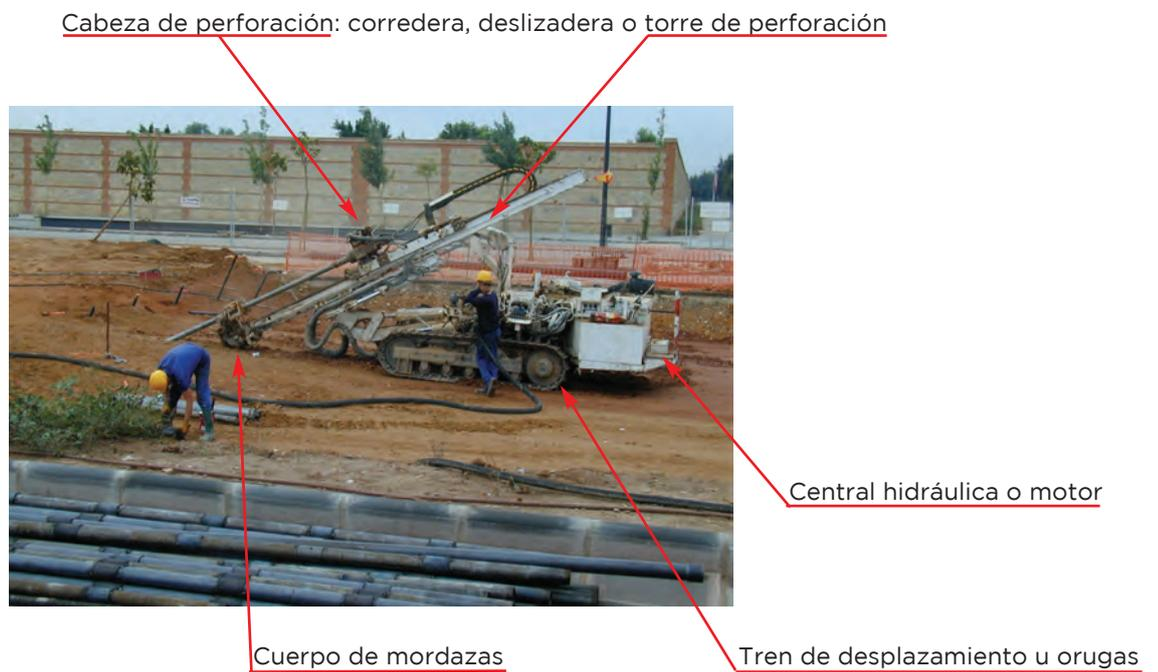
**Figura 9.** Partes de una perforadora. Fuente: Aetess
