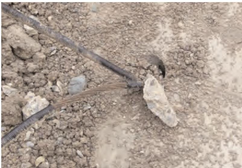
Fotografía 4. PROTECCION ANTE LA CORROSION DEFICIENTE EN ANCLAJES PERMANENTES.
