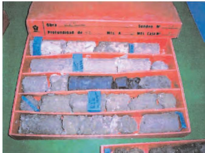
Fotografía 11. VISTA DE DETALLE DEL SONDEO N° 3, DE 4,50 A 9,60 m DE PROFUNDIDAD. CAJA 2 DE 3.
