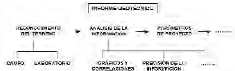
Figura 2. ESQUEMA DEL CONTENIDO DE UN INFORME GEOTECNICO.
