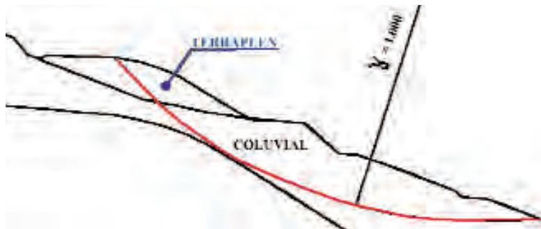
Figura 4.8. ANALISIS RETROSPECTIVO DE LA ROTURA.
