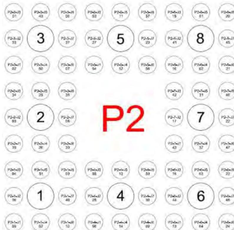
Figura 4.2. DISTRIBUCIÓN DE LOS 8 PILOTES Y 64 COLUMNAS DE JETGROUTING BAJO LA CIMENTACIÓN DE LA PILA “P2”.
