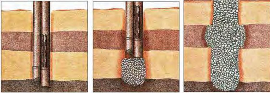
*Figura n°9. Esquema procedimiento de ejecución Bottom Feed.*
