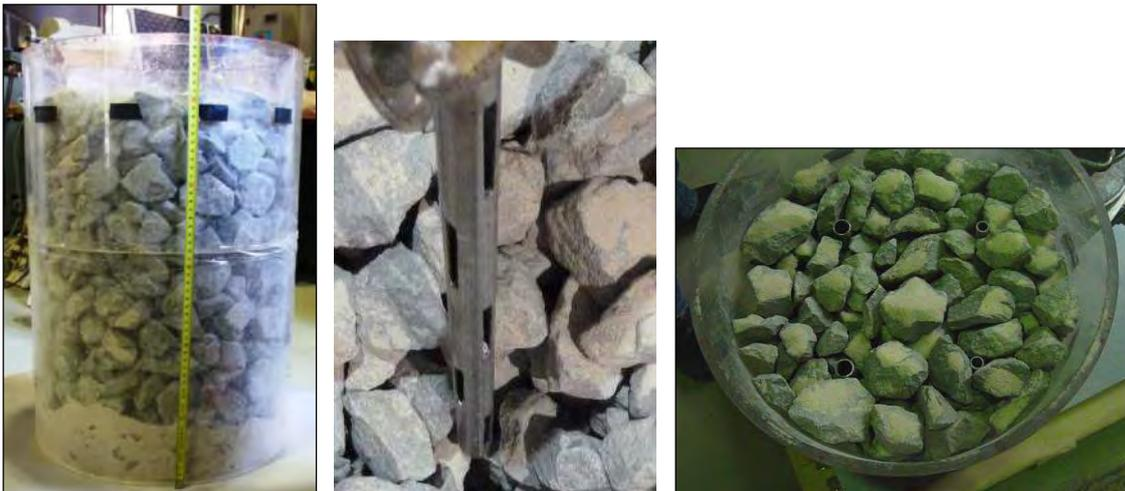
**Figura 25.- Calibración del endoscopio en células triaxiales de gran tamaño**
