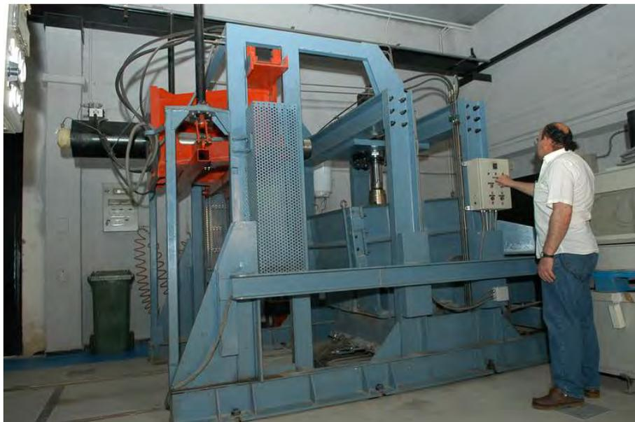
**Foto 5.3. Detalle lateral del aparato de corte directo de 1×1×1 m<sup>3</sup>
