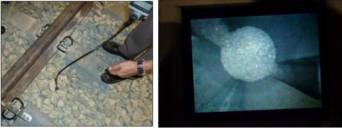
**Figura 20.- Endoscopio para determinar el grado de contaminación del balasto**
