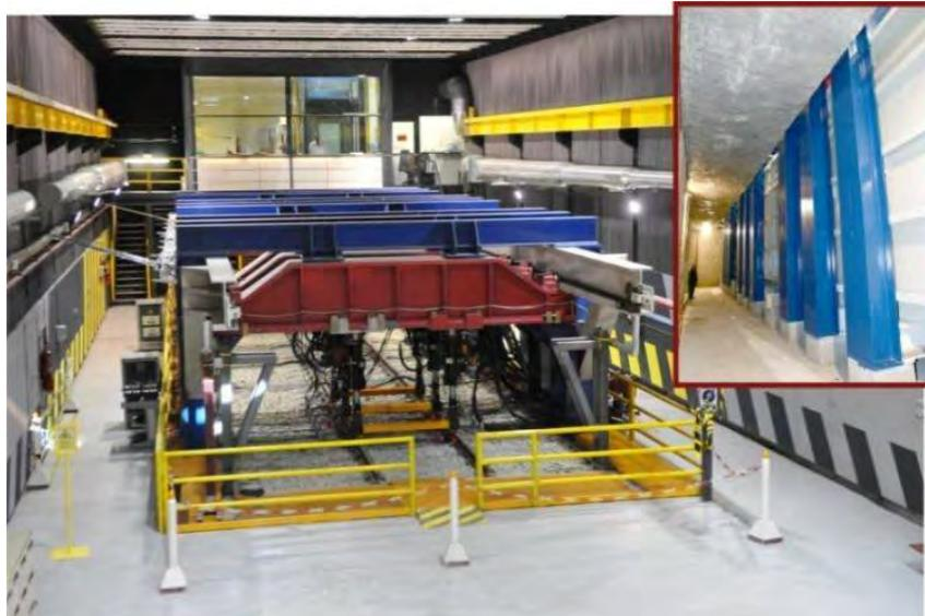
**Figura 5.- Zona del CFC donde se ha ensayado el modelo a escala 1:1 de una vía de la LAV Meca-MEDINA**
