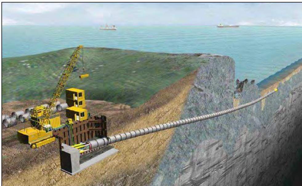
Figura 3. Emisario submarino ejecutado mediante hinca de tubería
