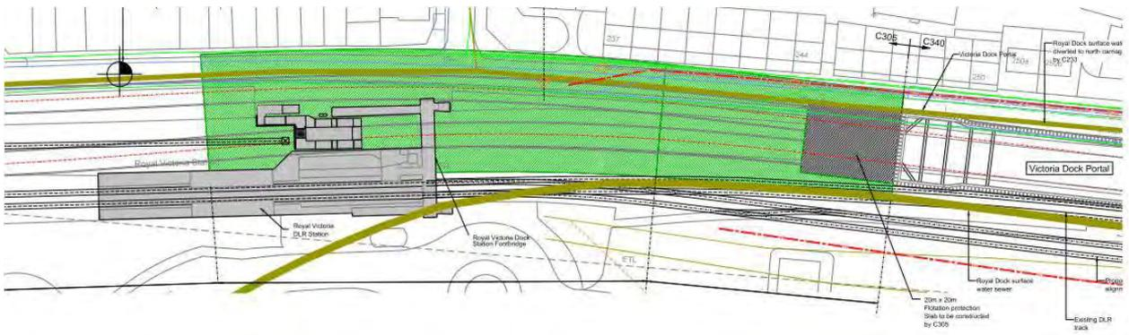
Figura 2. Planta de la llegada de las tuneladoras al portal, mostrando la zona a tratar según proyecto
