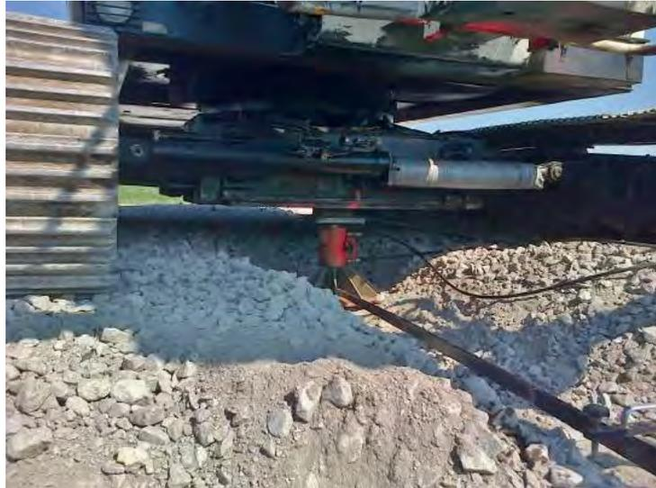
Foto 9. Prueba de carga estática con equipo de hinc como elemento de reacción.
