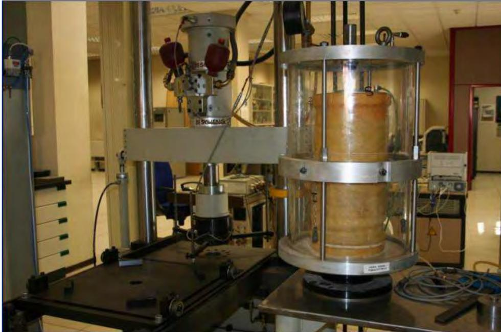
**Figura 24.- Célula triaxial de gran tamaño para balasto (partículas hasta 60 mm)**
