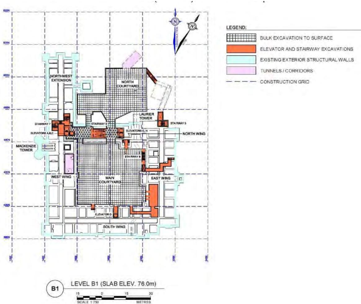
Figura 12: Diseño de Áreas de excavaciones principales. Plano 2.1 Nivel B1
