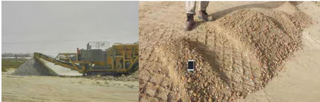
***Figura nº13 – Detalle del material empleado en el colchón de reparto.***
