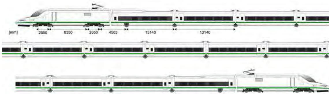
**Figura 4.- Distribución de ejes y bogies en el tren TALGO 112 que operará la LAV**
