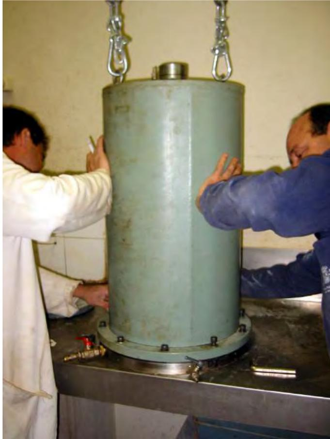
**Foto 5.4. Detalle del montaje de la célula para ensayos triaxiales con muestras de Ø9"
