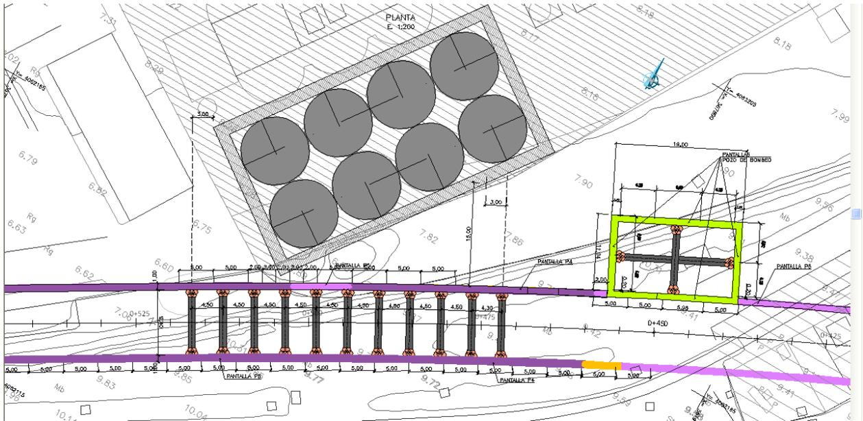
a) Planta silos y acodamiento pie de pantallas en túnel de línea y pozo de bombeo inicial
