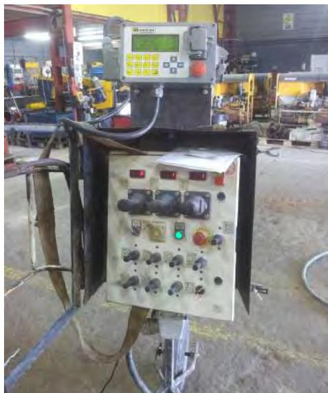
Figura 29. Panel de control de la perforadora con la pantalla de control del registrador de parámetros encima
