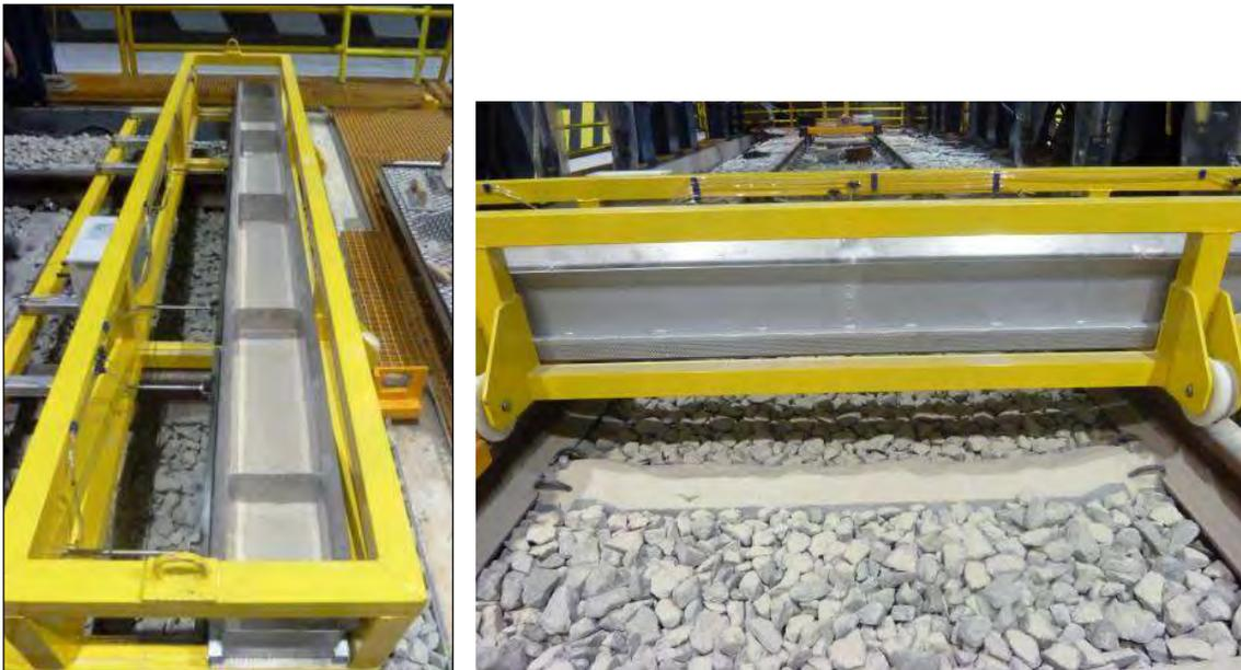
Figura 19.- Equipo para la contaminación del balasto diseñado en el CEDEX
