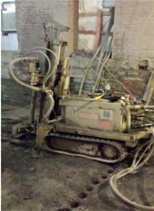
*Figura 43: Carro hidráulico TES 20*
