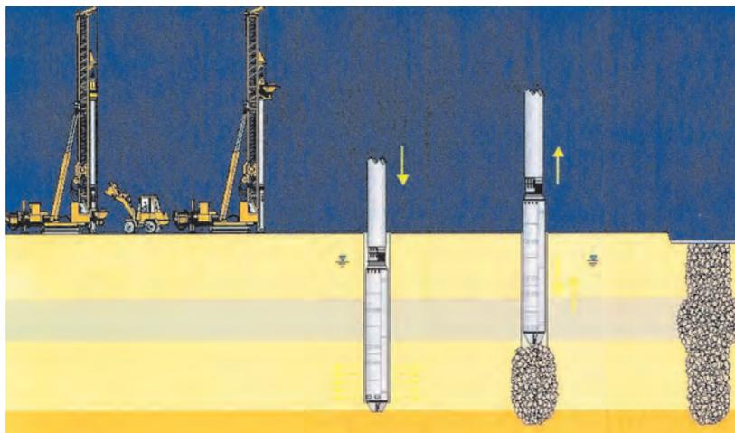
Figura 7. PROCEDIMIENTO DE EJECUCIÓN DE COLUMNAS DE GRAVA EN VÍA SECA (Keller Group, 2000).
