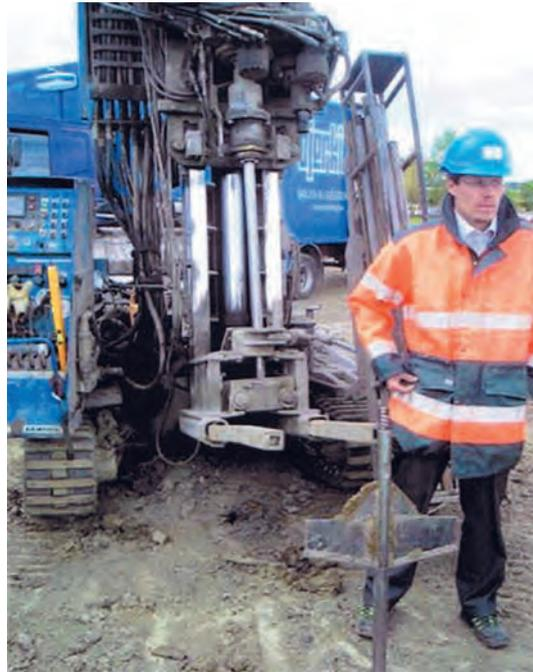
Foto 5. MAQUINARIA PARA EJECUCIÓN DEL ENSAYO DE PENETRACIÓN CONVENCIONAL.
