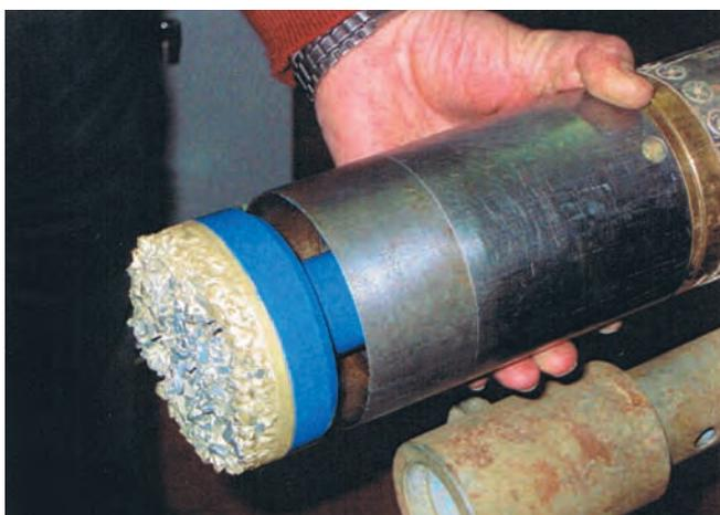
Foto 7. CABEZAL ESPECIALMENTE DISEÑADO PARA EL SONDEO DE SUELOS ARCILLOSOS.
