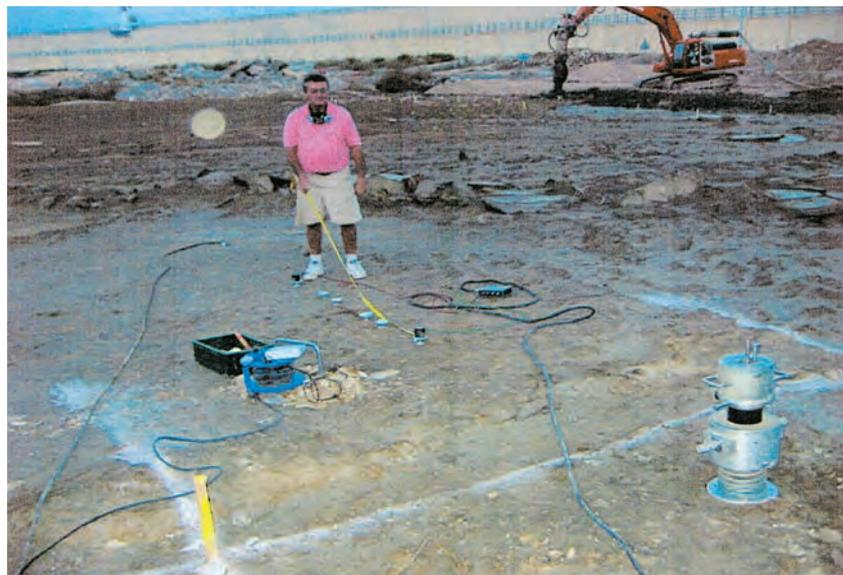
Foto 2. ESQUEMA DE TRABAJO DEL ANÁLISIS ESPECTRAL DE ONDAS SUPERFICIALES.
