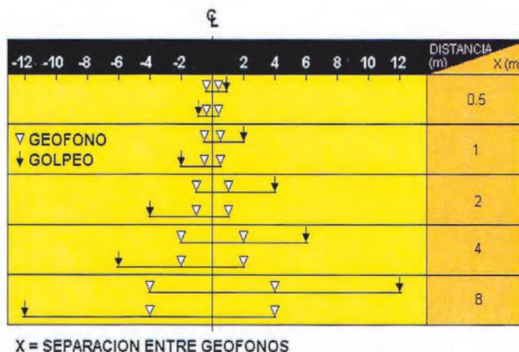
Figura 3. DISPOSICIÓN DE GEÓFONOS EN EL CAMPO.
