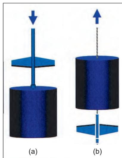
Figura 14. ENSAYOS DE PENETRACIÓN: a) CONVENCIONAL. b) INVERSA DE UNA COLUMNA DE CAL-CEMENTO.
