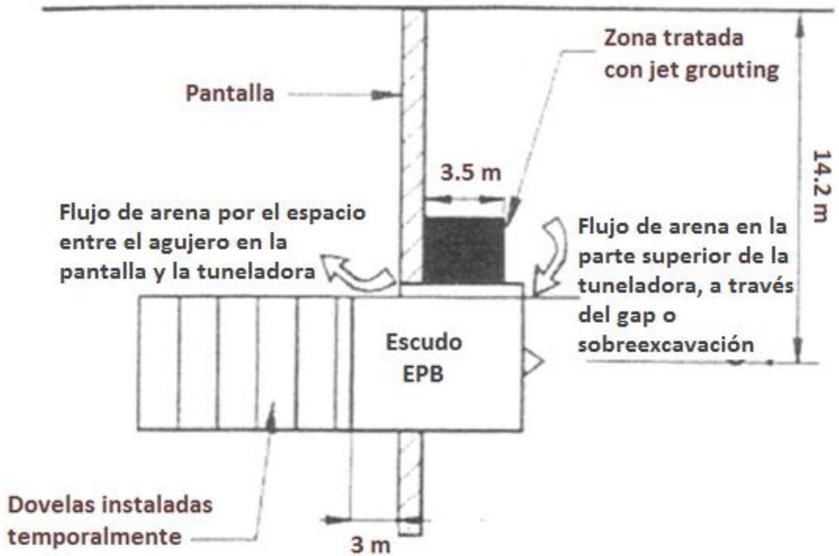
**Figura 17.** Jet grouting para el cierre del gap en los pozos de salida de tuneladoras, en suelos arenosos
