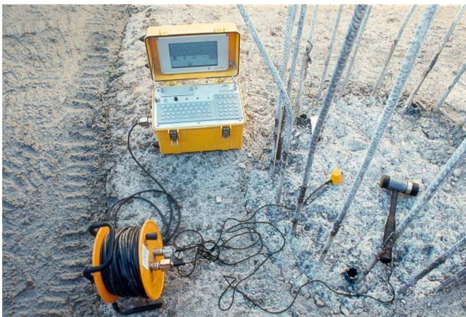
FIG. 3.1.- EQUIPO DE IMPEDANCIA MECÁNICA Y SENSORES DE MEDIDA SOBRE EL PILOTE
