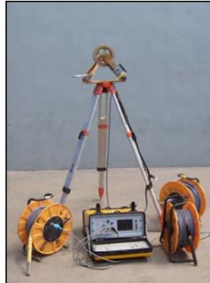
FIG. 2.10.- EQUIPO COMPLETO DE TRANSPARENCIA SÓNICA CON BOBINAS DE CABLE
