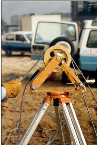
FIG. 2.8.- TORNO DE MEDIDA DE LA PROFUNDIDAD
