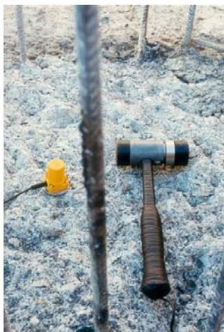
FIG. 3.23.- MARTILLO INSTRUMENTADO CON CÉLULA DE CARGA
