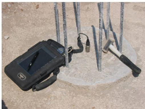
FIG. 3.2.- ENSAYO DE ECO
