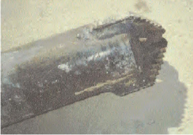
*Fig.6b - Armadura-varilla acoplada a una trialeta perdida de Ø220 mm. Grand Littoral, Marsella, 2000*
