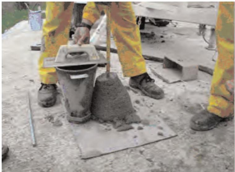
Fig. 18: Control asiento en Cono de Abrams (< 4 a 5 cm)
