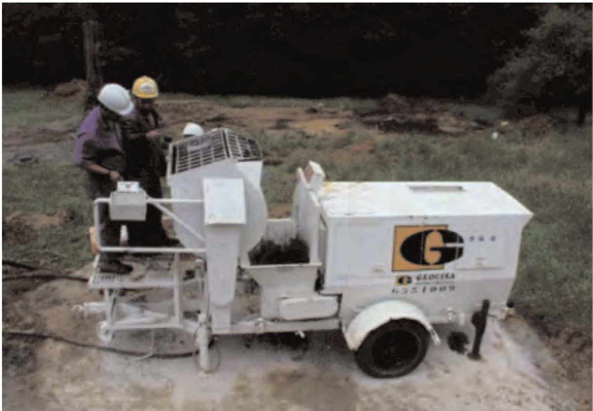
Fig. 17: Bomba para inyección de morteros "secos"
