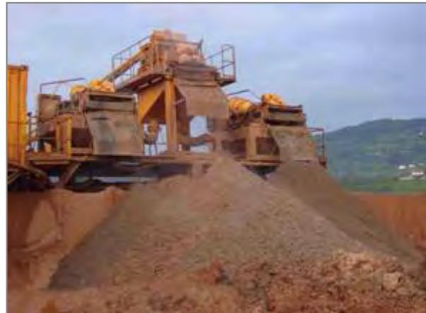
Figura 25. Planta de hidrofresa para la separación del detritus de excavación
