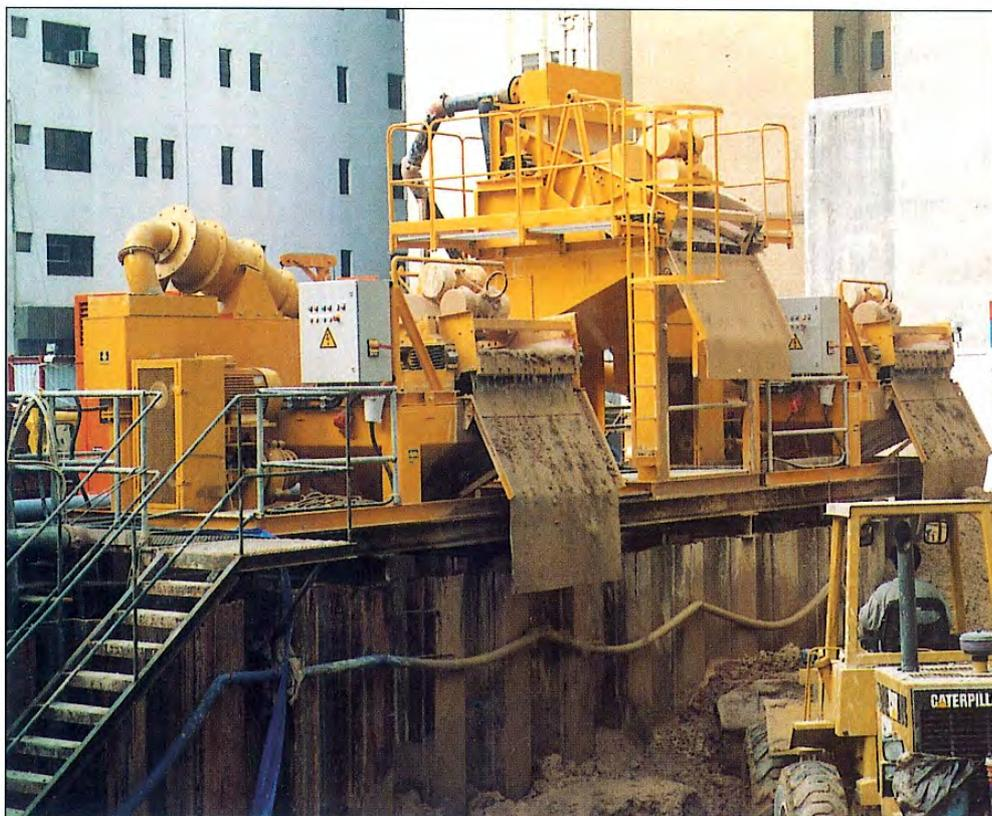
**Figura 23** Vista general de un desarenador de 500 m<sup>3</sup>/hora (Bauer, 1997)
