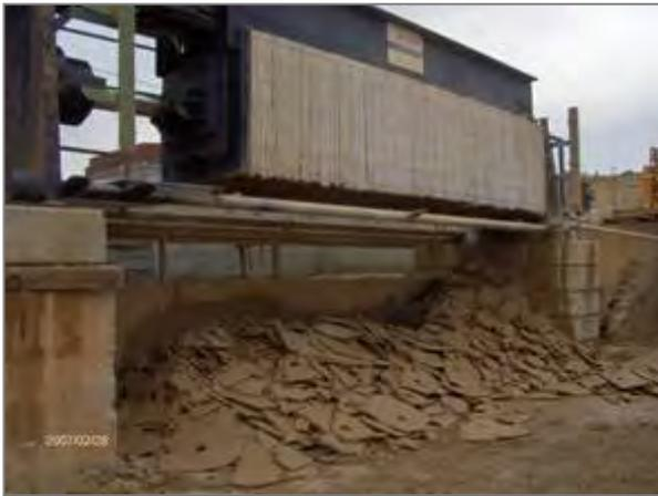
Figura 26. Filtro prensa para el tratamiento de lodos de desecho
