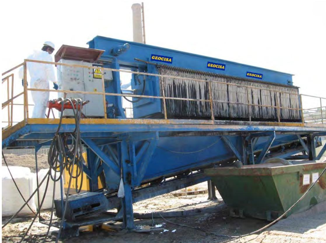
**Figura 24** Vista general de un filtro prensa (Geocisa, 2007)
