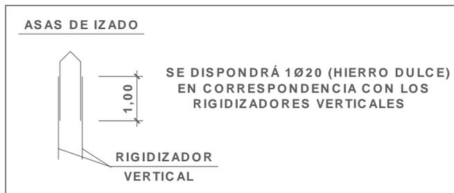
Figura 36. Detalles de asas de izado y cuelgue de armaduras de pantalla
