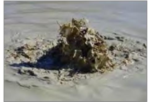
Figura 16. Lodo bentonítico en agitación para su hidratación y uso posterior
