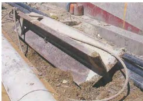
**Figura 18** Trépano utilizado para la excavación de terrenos rocosos (Oteo, 2007)
