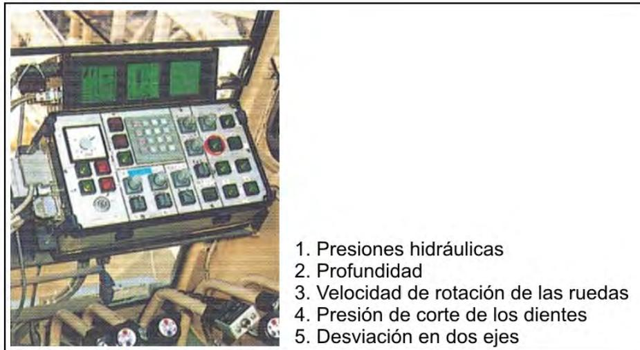
**Figura 15** Registrador de parámetros del equipo (Bauer, 1997)
