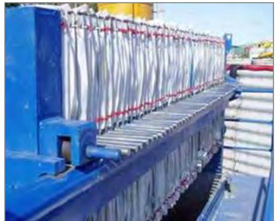
Figura 27. Mallas de tela para la separación de la materia seca por prensado del lodo
