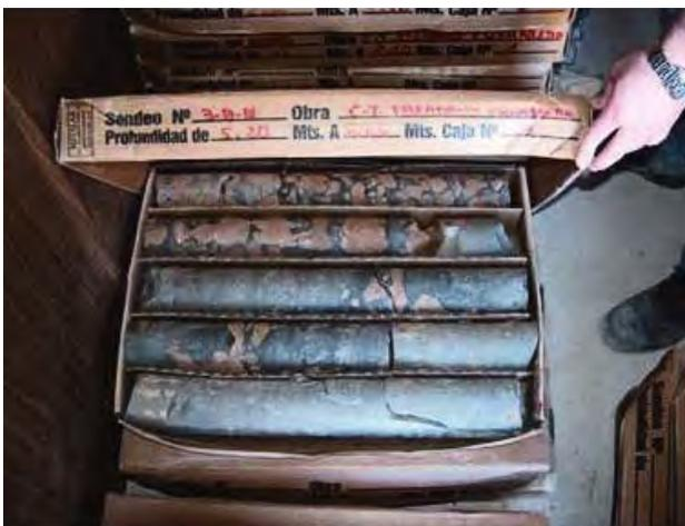
Figura 45. NÓDULOS DE ARCILLAS EMBEBIDAS EN EL TRATAMIENTO.
