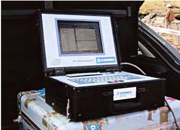
Figuras 30. ANALIZADOR ELECTRÓNICO DE HINCA.
