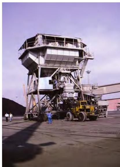
Figura 6. TOLVA MÓVIL DE DESCARGA DE CLINKER.
