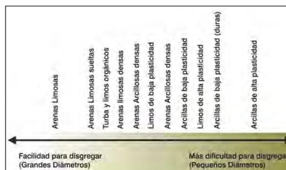
Figura 25. FACILIDAD DE DISGREGACIÓN EN DIFERENTES TIPOS DE TERRENO.
