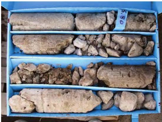
**Figura 43. EXTRACCIÓN DE TESTIGO MUY DISCONTINUA.**
