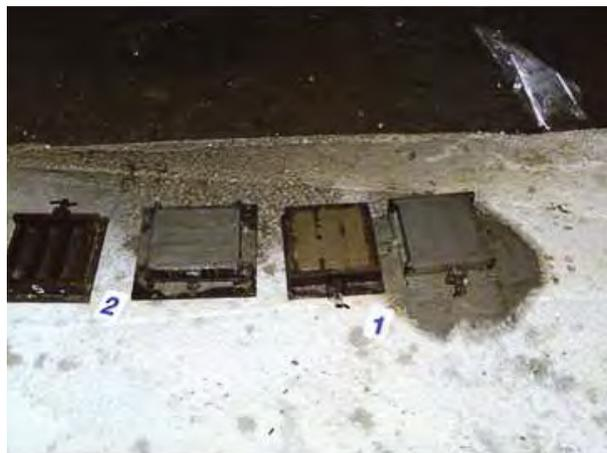
Figura 53. PREPARACIÓN DE PROBETAS A DISTINTAS PROFUNDIDADES PARA SU ENSAYO.
