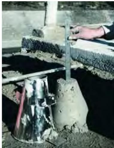
Figura 57. MORTERO SECO Y MEDIDA DEL ASIENTO (Detalle).
