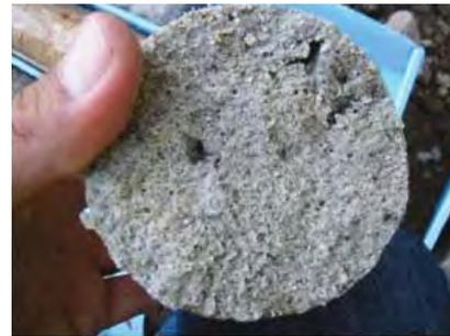
Figura 48. TESTIGO DE *JET* EN ARENAS (Detalle interior).
