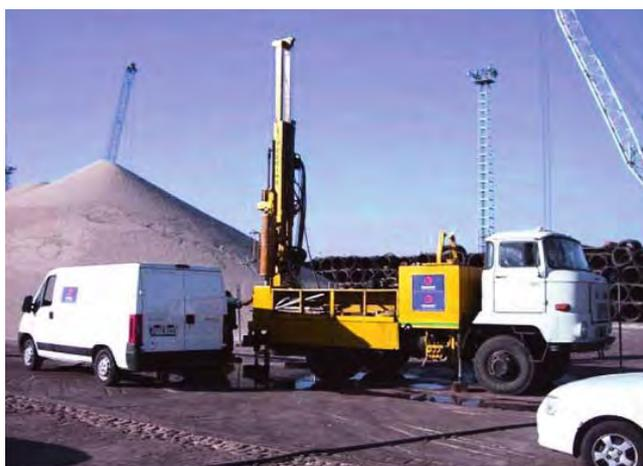
Figura 40. EXTRACCIÓN DE TESTIGOS EN EL PUERTO DE HUELVA.
