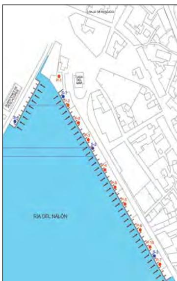
Figura 7. PLANTA DE SITUACIÓN DE PENETRÓMETROS Y SONDEOS DE ROTACIÓN.
