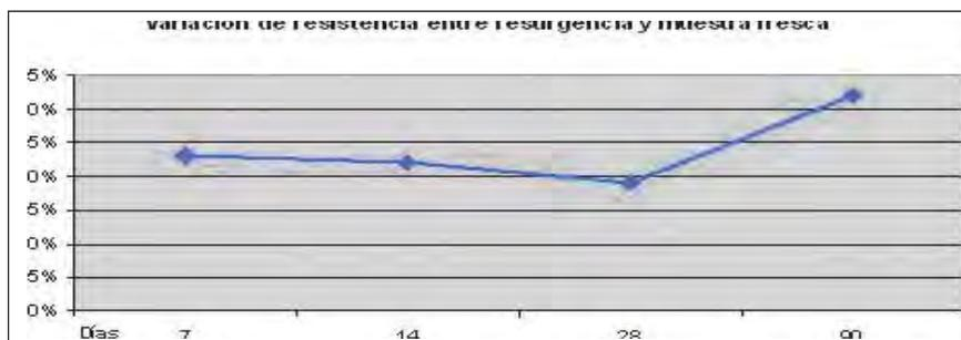
Figura 55. VARIACIÓN DE RESISTENCIA ENTRE RESURGENCIA Y MUESTRA FRESCA.
