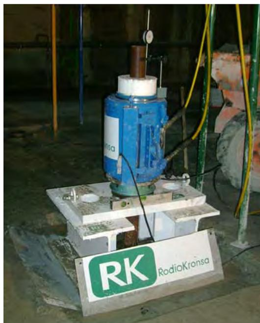
**Fig. 7 – Prueba de carga estática**
