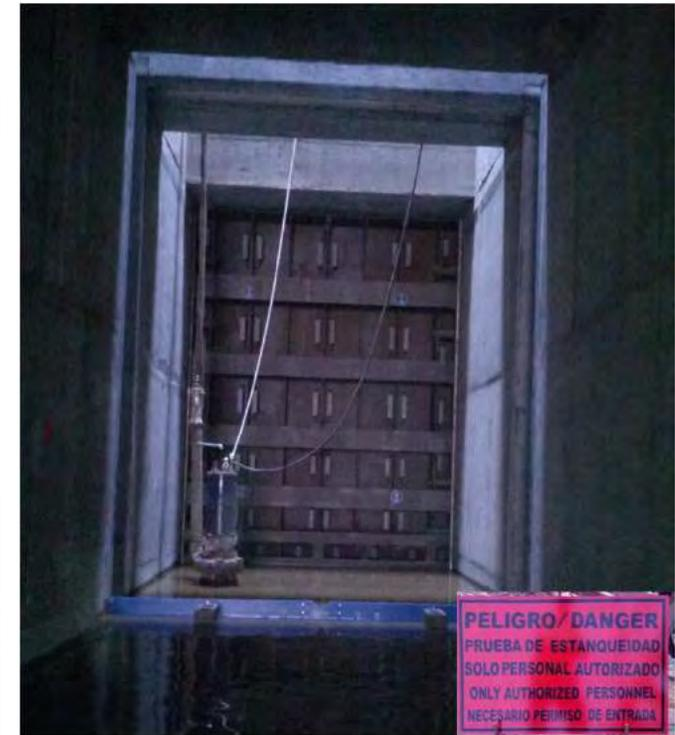
Se realizó la prueba de estanqueidad de la mayor parte de las válvulas principales con un mamparo especial antes de la inundación de las esclusas.
