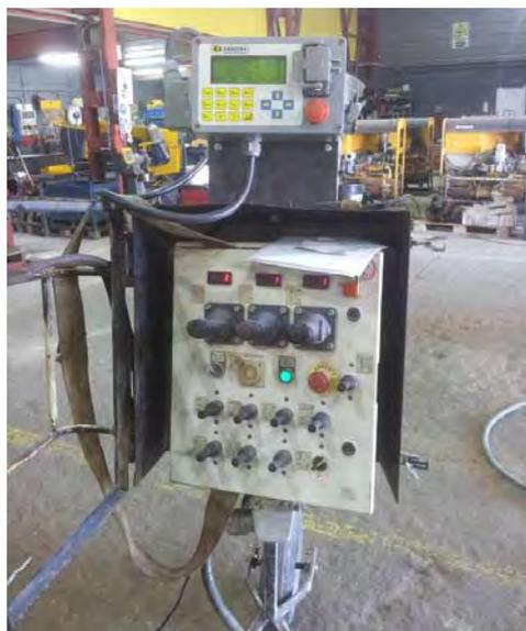
Figura 17. Panel de control de la perforadora con la pantalla de control del registrador de parámetros encima
