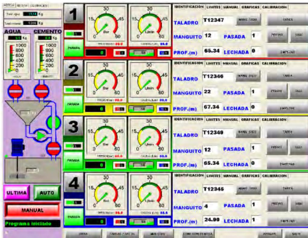
Figura 23. Vista de la pantalla del sistema automático de programación de las inyecciones
