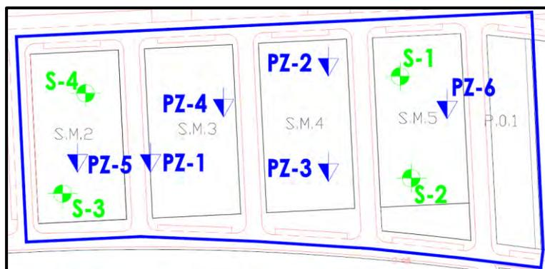
Figura 4: Localización de los sondeos y ensayos de penetración.
