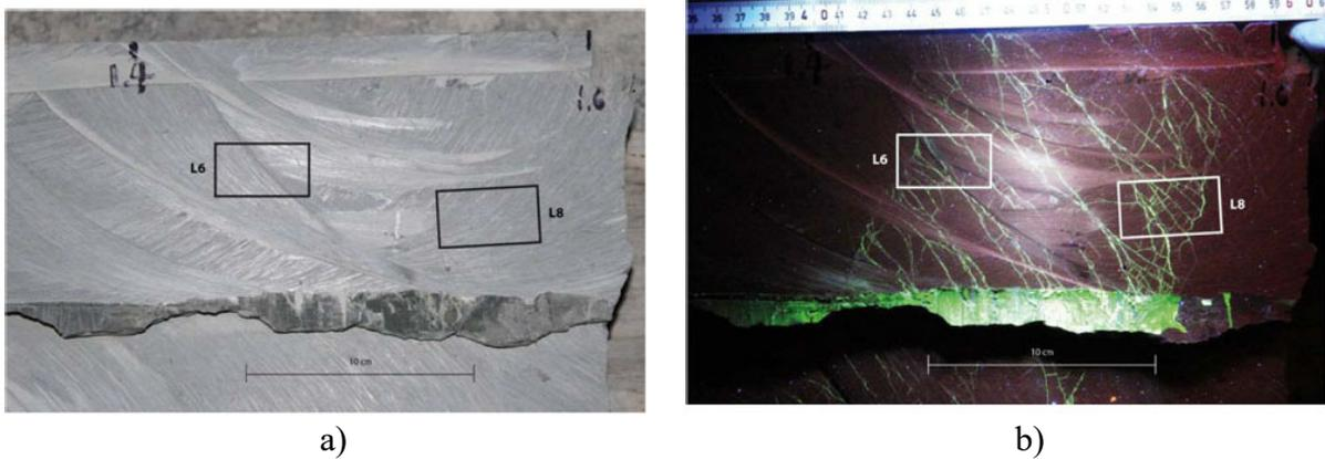
Figura 6. Procedimientos de reconocimiento de fracturas. a) testigo(overcoring) impregnado de resina, b) testigo(overcoring) impregnado de resina bajo luz fluorescente [9]
