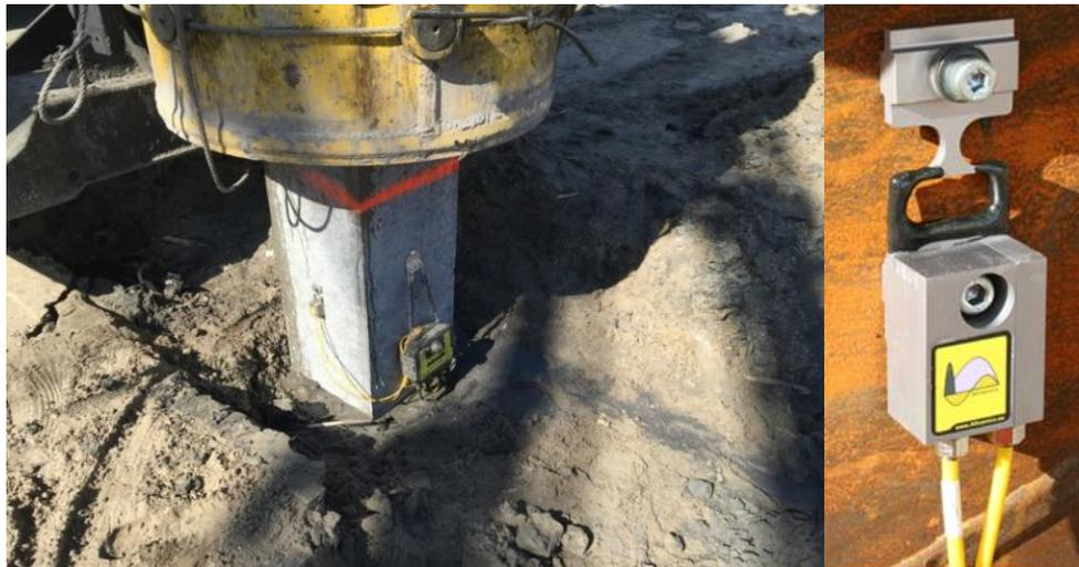
**Figura 10.** Equipo PDR. Transductores sobre la cabeza de un pilote y detalle de Sensor combinado extensómetro y acelerómetro.
