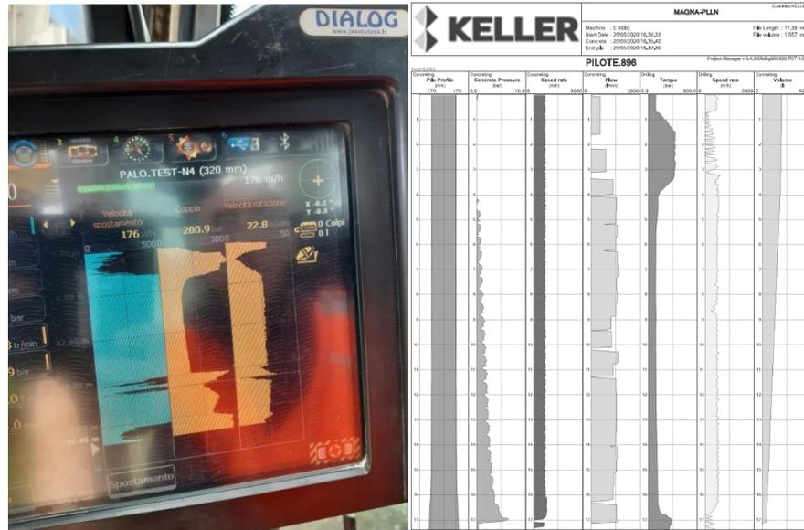
**Figura 20.** Sistema de generación de informes y adquisición de datos de la inclusión rígida.
