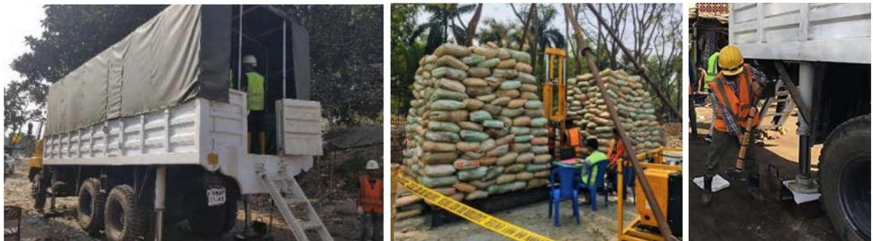
*Figura 28. Diferentes formas de proporcionar reacción al avance del cono en el terreno y golpeo para generación de onda de corte*
