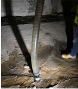
Figura 8. Control nivel piezométrico
