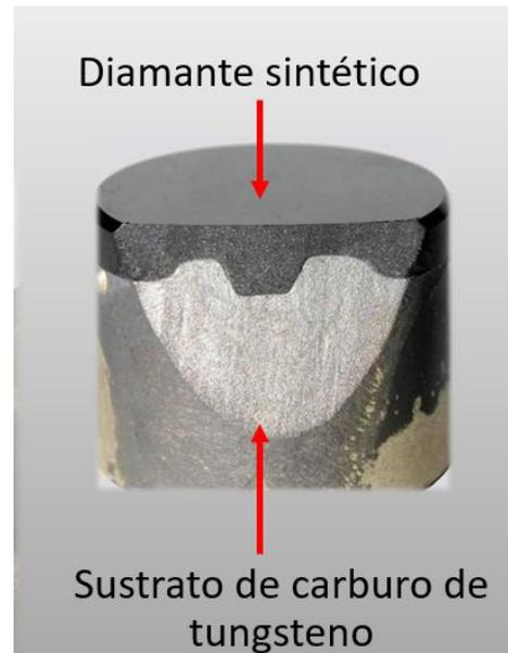
Figura 20: Detalle de los bits de PCD
