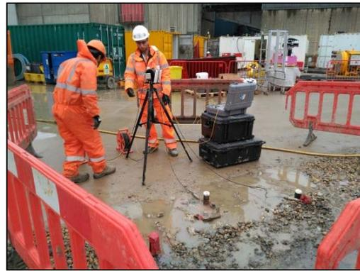
Figura 31: realización ensayo Cross-hole
