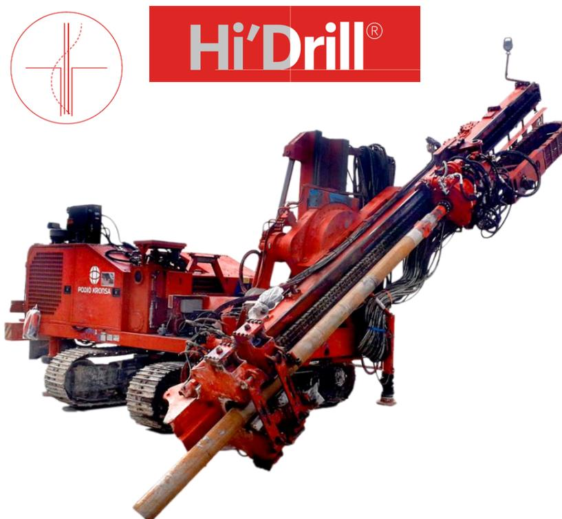
Figura 1. Equipo de perforación equipado con cabezal sónico – “Hi`Drill”.
