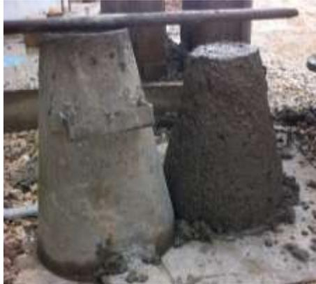
Figura 20. Detalle ensayo de cono del mortero
