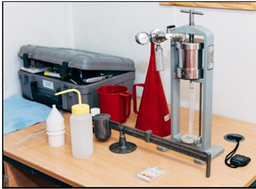
Figura 29: Laboratorio de obra con equipos para ensayos de lodos
