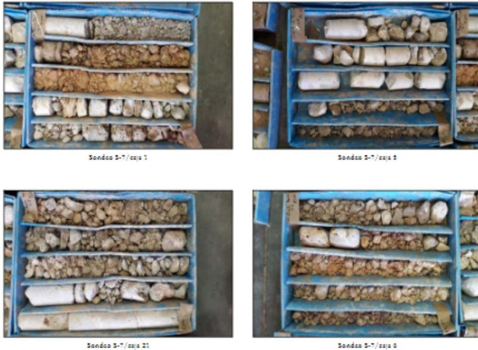
Figura 7. Fotografías de las cajas de los testigos (Sondeo)
