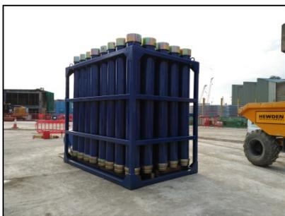
Figura 26: Jaula tubería tremie
