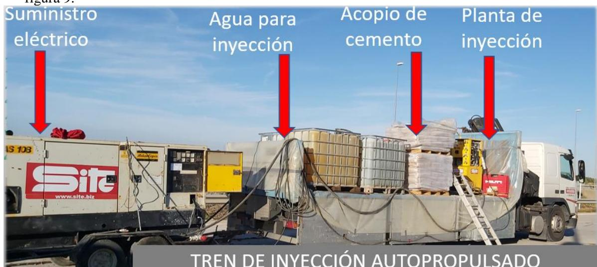
Figura 9: Planta de inyección autopropulsada
